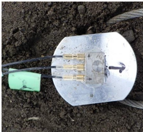
図 4.1.2.3-8 加速度センサー TEAC 612ZS
