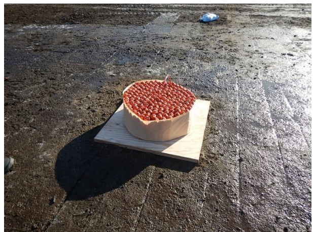
図 4.2.2.1-4 実験 No.2 の装薬状況 (EMX2 80 kg 令和 4 年 11 月 23 日)
