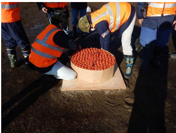
図 4.2.2.1-4 実験 No.2 の装薬状況 (EMX2 80 kg 令和 4 年 11 月 23 日)
