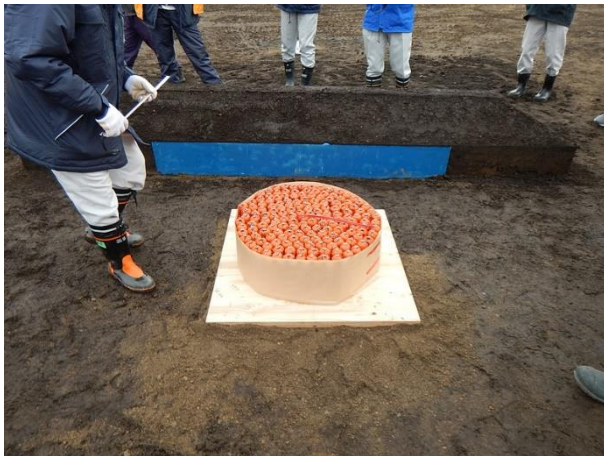
図 4.1.2.1-6 実験 No.1-3 の装薬状況 (EMX2 80 kg 令和 4 年 11 月 20 日)
