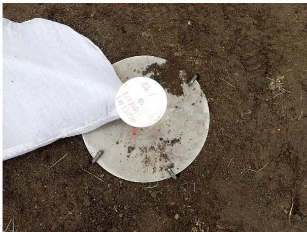
図 4.1.2.3-3 爆風圧計設置状況写真 (左 : ch1 のセンサー、右 : ch2 から ch4 のセンサー)
