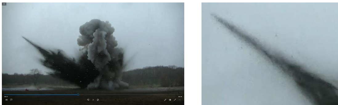
図 4.1.3.3-5 映像解析による飛散物初期位置 X_0 と初速度ベクトル V_0 の推定 （左：実験 No.1-1 高速度カメラ映像、右：拡大図）
