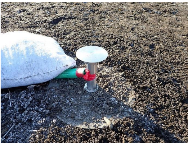
爆風計測架台
