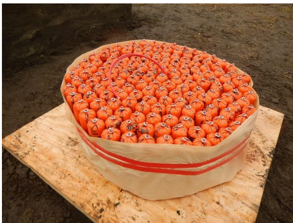
図 4.1.2.1-4 実験 No.1-1 の装薬状況 (EMX2 80 kg 令和 4 年 11 月 19 日)
