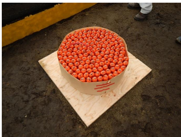
図 4.1.2.1-5 実験 No.1-2 の装薬状況 (EMX2 80 kg 令和 4 年 11 月 22 日)
