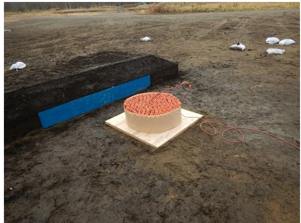
図 4.1.2.1-6 実験 No.1-3 の装薬状況 (EMX2 80 kg 令和 4 年 11 月 20 日)
