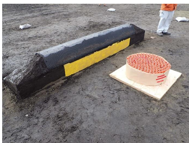
図 4.1.2.1-5 実験 No.1-2 の装薬状況 (EMX2 80 kg 令和 4 年 11 月 22 日)
