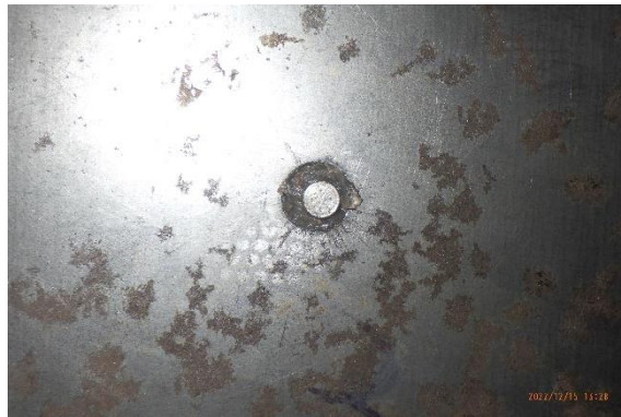
図5-4 実験台に固定した圧力センサー（換算距離4.58 ~ 18.33 m/kg 1/3 の場合）
