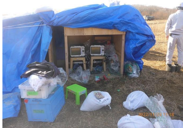
計測ボックス内の地盤振動計測機器
