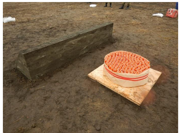
図 4.1.2.1-4 実験 No.1-1 の装薬状況 (EMX2 80 kg 令和 4 年 11 月 19 日)
