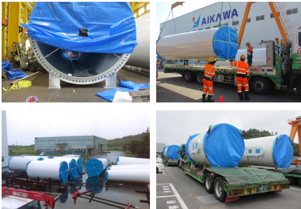
図 6-10 タワー部の製造 (出典：会川鉄工 HP)
