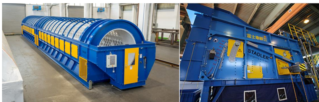
図 3.2-7 (a) ドラムスクリーン (b) バリスティックセパレーター
