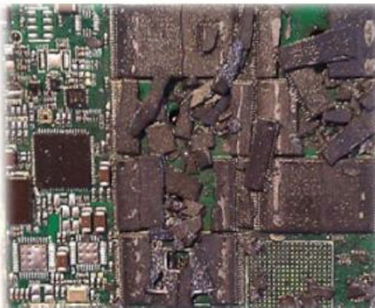
① 改ざん検出に応じて破壊されたチップの事例
