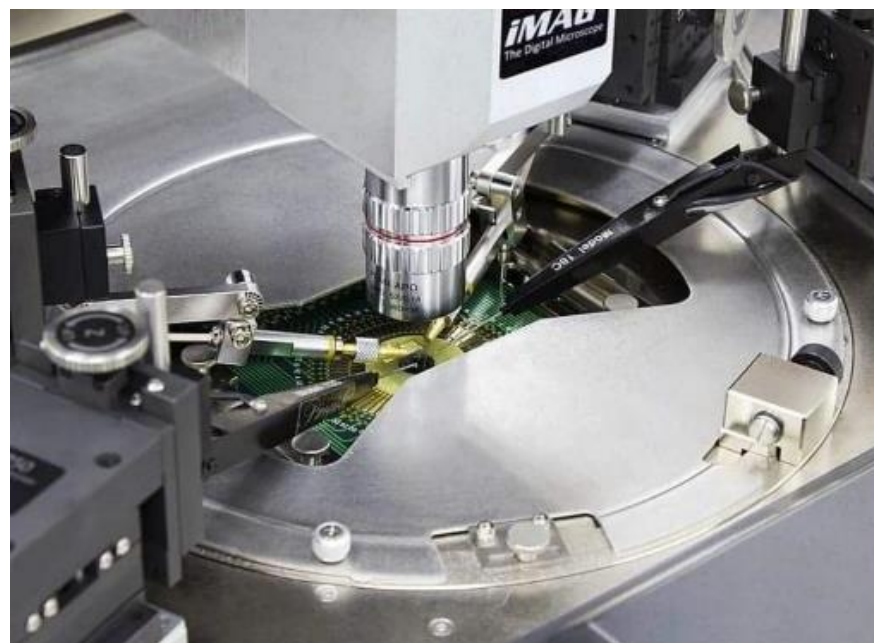
半導体の故障解析に用いる電氣的マイクロプロービング
