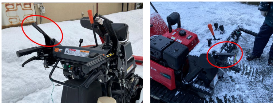
図 45 角型デッドマンクラッチ例（利用者提供）
