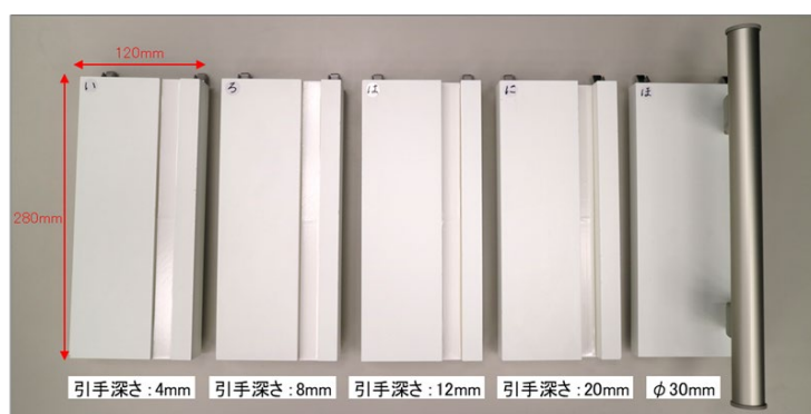
図 70 操作部品（左から、掘込み引手：4mm, 8mm, 12mm, 20mm、ハンドル）
