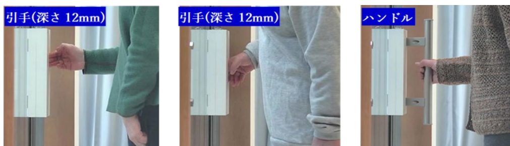
図 78 手指のかけ方（引手深さ 12mm、ハンドル、開閉力 20N）
