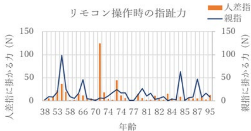
図 96 リモコン操作時の指に掛かる力
