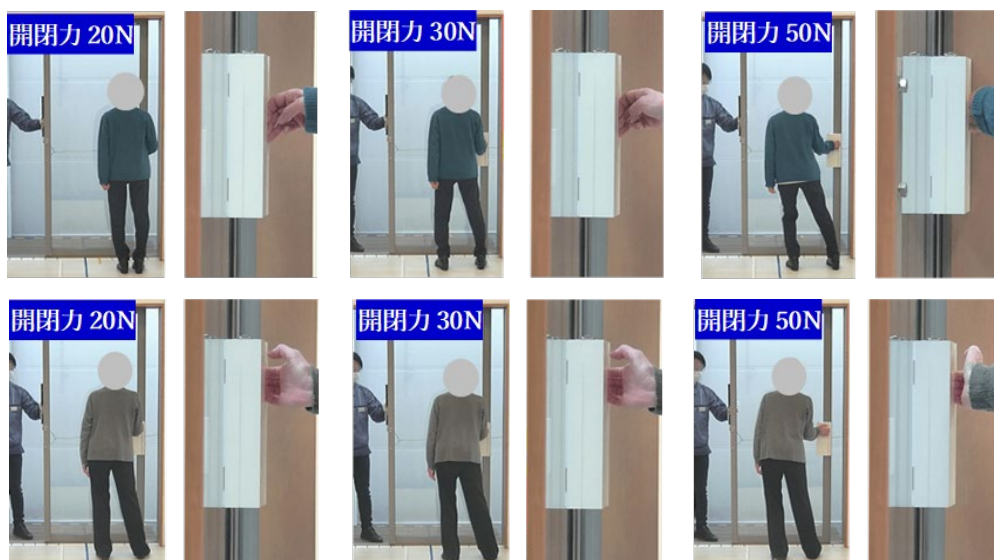
図 79 引戸を開ける操作（引手深さ 8mm、左から開閉力 20N、30N、50N）
