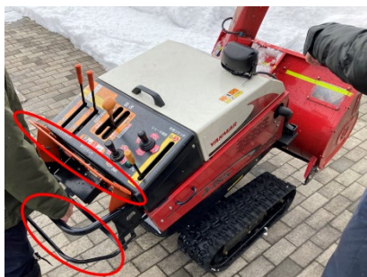
図 46 ループ型デッドマンクラッチ例（利用者提供）
