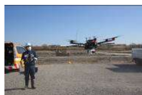
測量業務・進捗管理用ドローン
