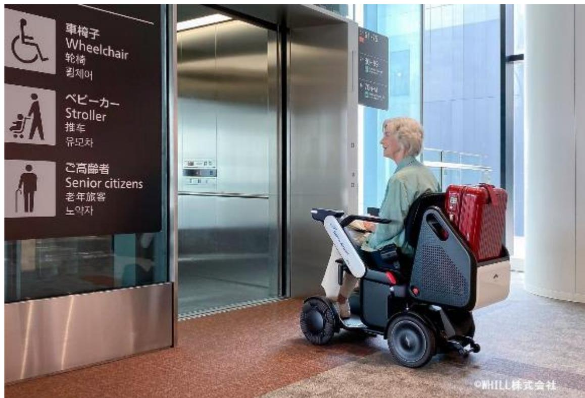
図3.1-9：WHILL自動運転モビリティサービスと連携したエレベータの様子
