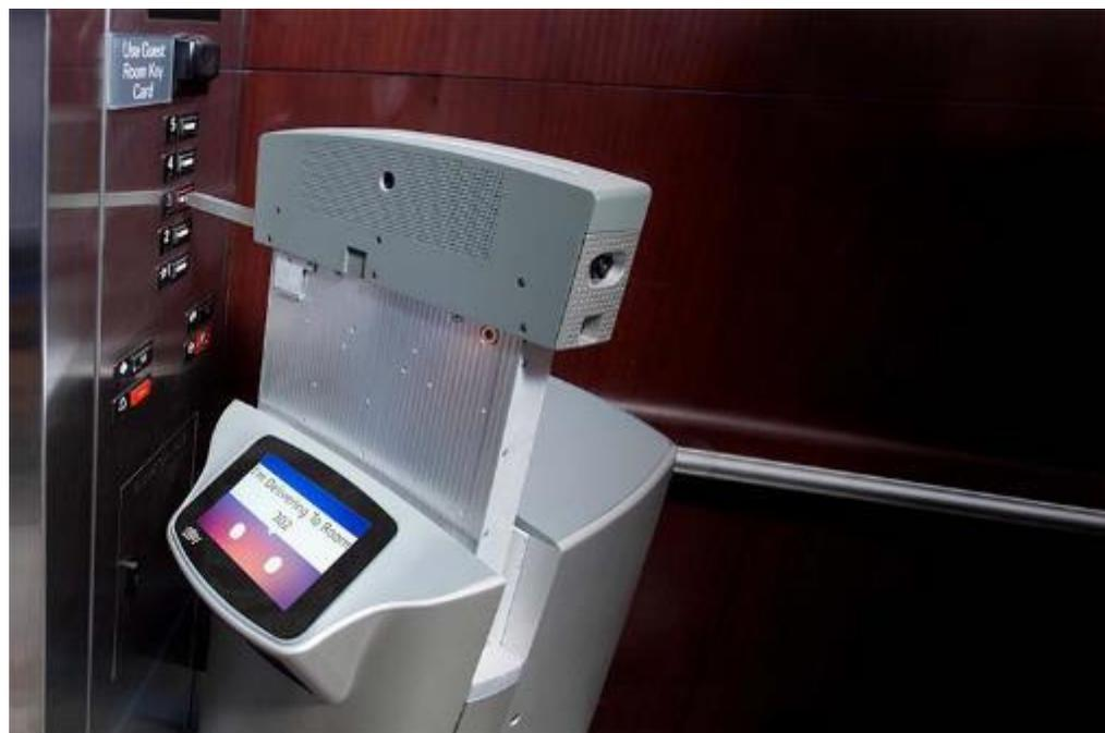
図3.1-12 : Relay+がエレベータを操作する様子
