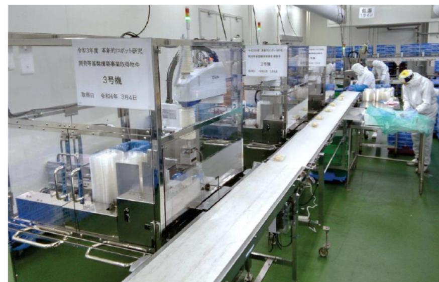
図3.2-19：惣菜盛付ロボットの現場導入事例
