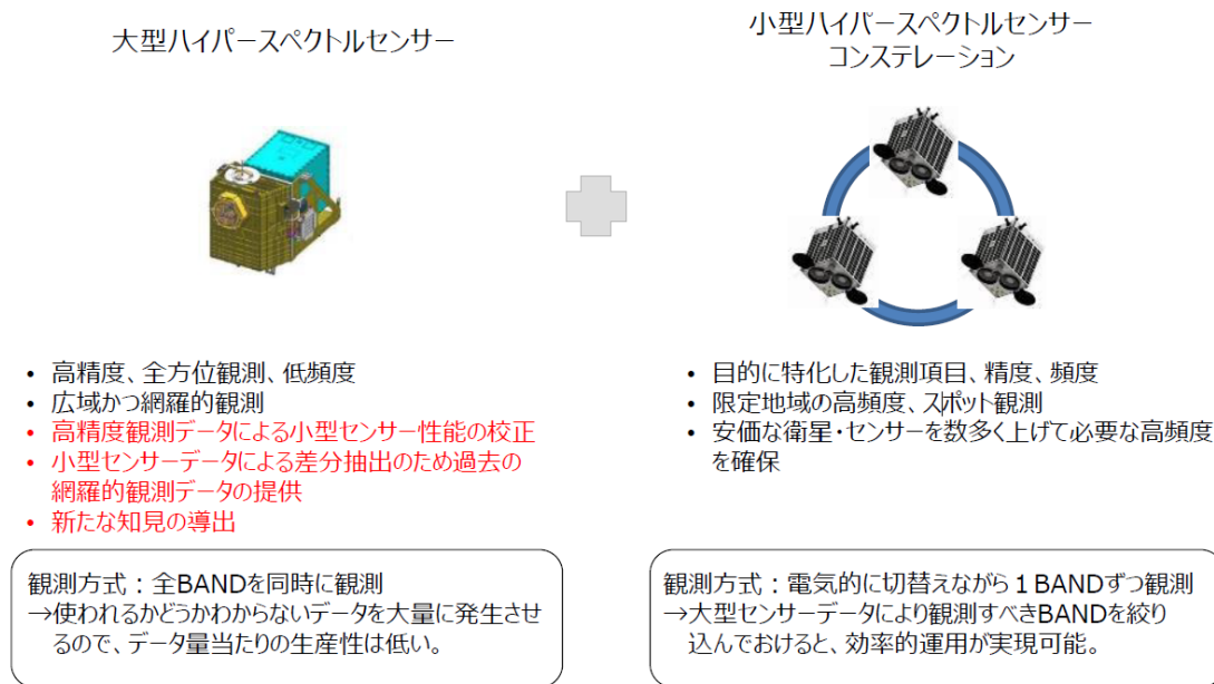
図 2-4 大型ハイパースペクトルセンサと小型ハイパースペクトルセンサコンステレーションの連携 出所)J-spacesystems 安達委員発表資料
