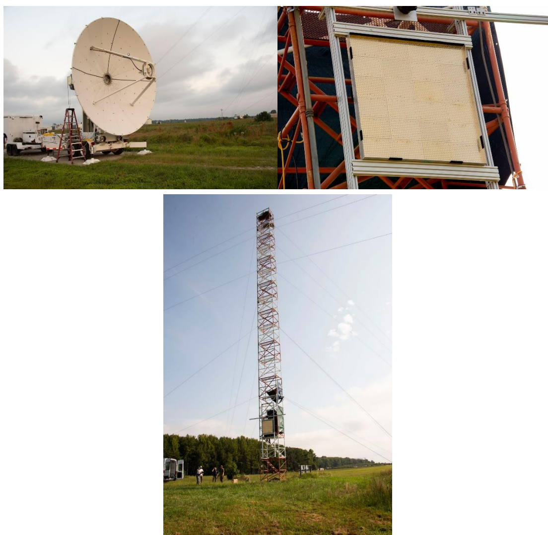
図 3-25 ブロッサムポイントで実施されたマイクロ波送電実験の送電アンテナ(左上)とレクテナ(右上と下) (Credit : NRL)
