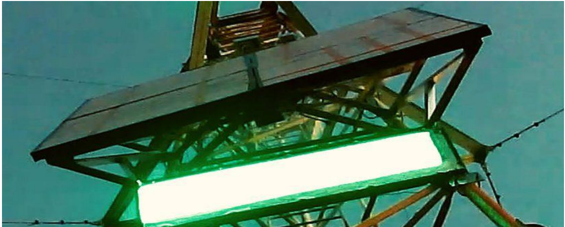
図 3-26 MIT の HUSIR 送信機を用いて実施されたマイクロ波送電による LED 点灯実験 (Credit : NRL) 出所) https://dsiac.org/articles/nrl-conducts-successful-terrestrial-microwave-power-beaming-demonstration-2/ (2022 年 12 月 26 日閲覧)
