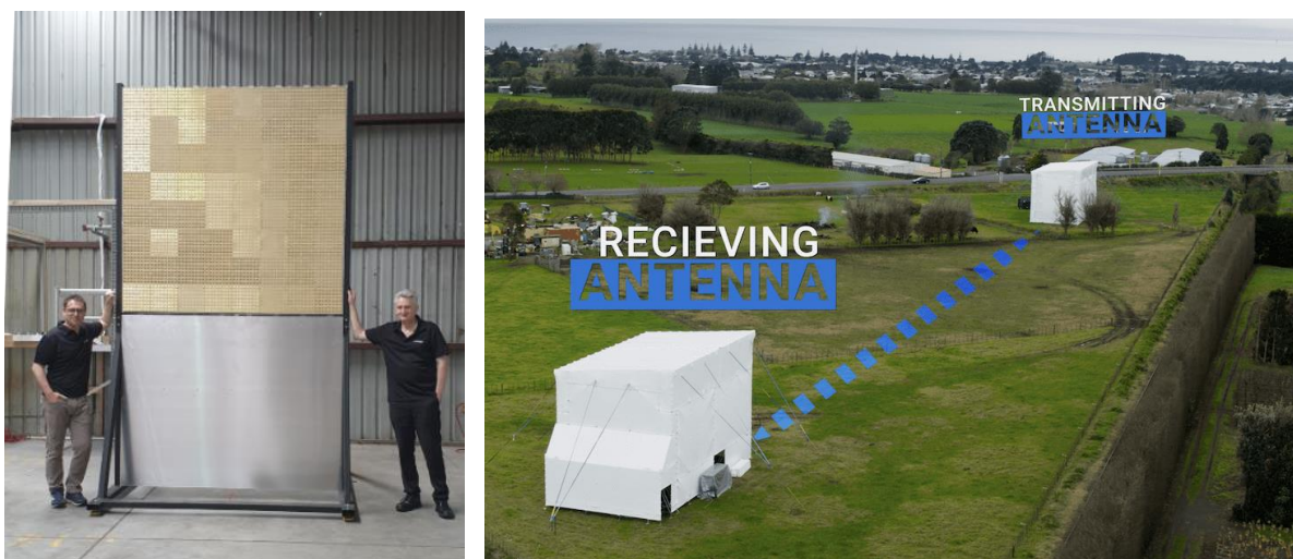
図 3-30 屋内試験のプロトタイプアンテナ(左)／フィールド試験の建屋(右)(Credit:Emrod)
