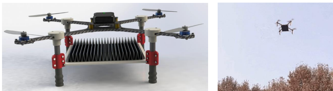
図 3-33 中国西北工業大学が開発した ODD (Optics-driven Drone)と飛行試験の様子
