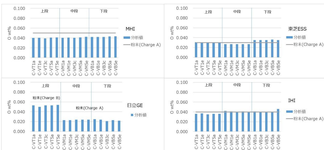
図 3.4.1(3)-10 造形物及び粉末の O 分析結果(日立 GE 粉末は O 分析値なし)
