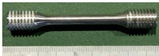
図 3.2.1(4)⑤-2 引張試験片外観例(IHI)
