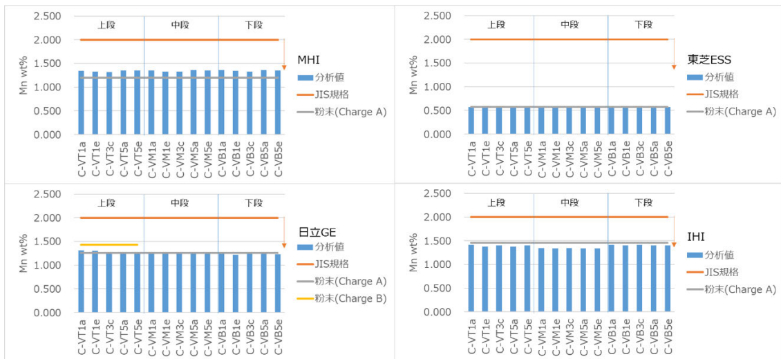
図 3.4.1(3)-3 造形物及び粉末の Mn 分析結果
