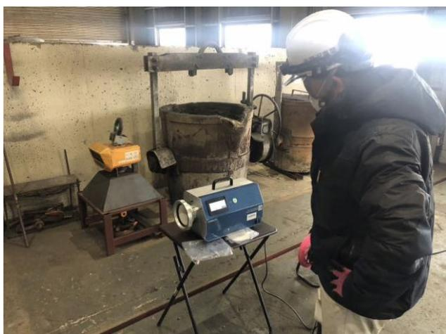
図 5.1.3. 空气中汚染濃度ダスト採取
