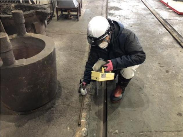
図 5.1.7. 鉄棒汚染検査
