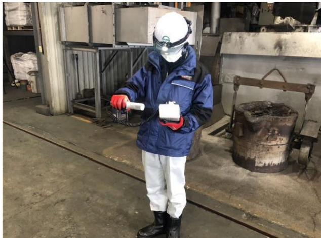
図 5.1.1. 溶融エリア空間線量当量率測定
