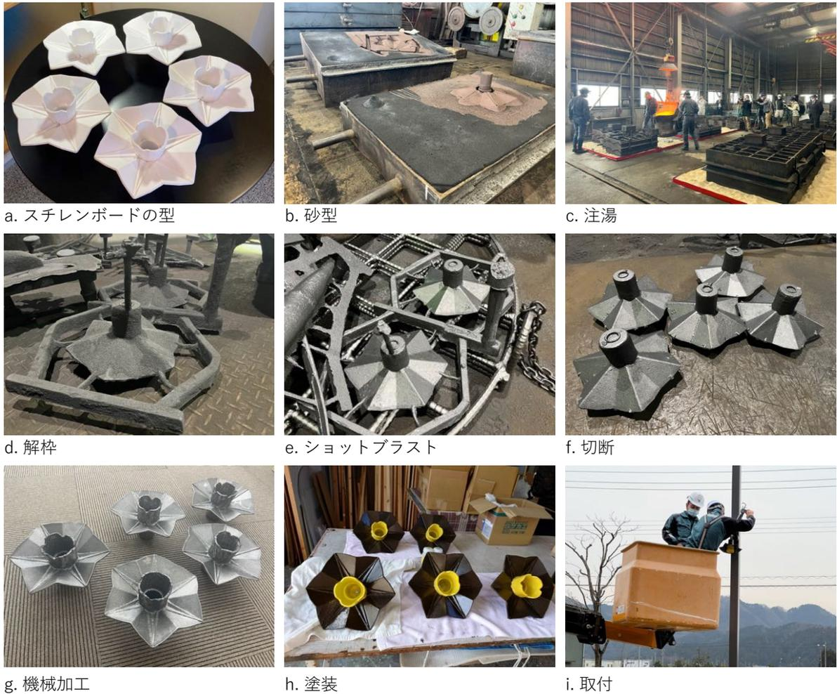
図 2-13 水仙照明の製造・取付工程
