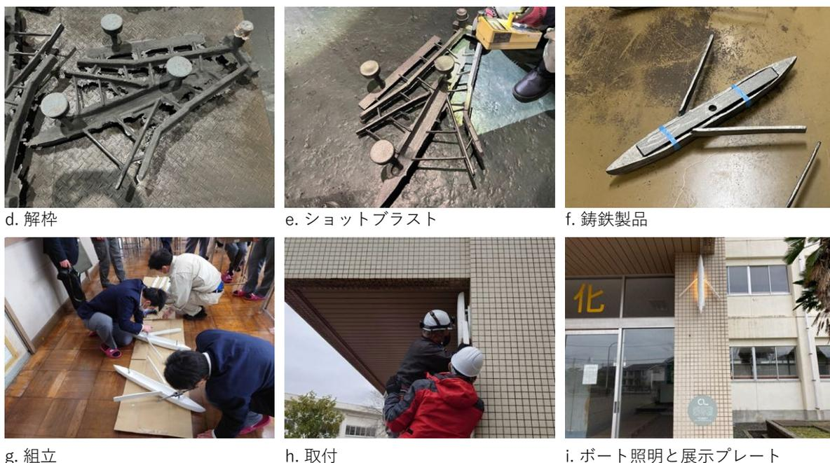
図 2-10 ポート照明の製造・取付工程
