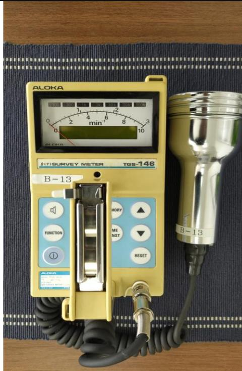
図 2. 3. 2. GM 管式サーベイメータ
