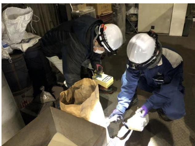
図 5.1.5. 添加物線量測定・汚染検査
