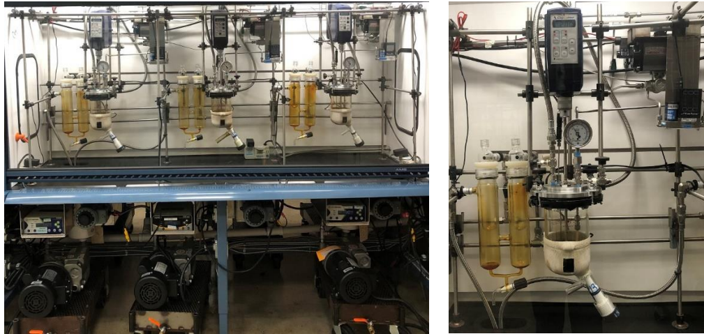
図 2-15. Romaszewski Oil Bench Oxidation (ROBO) 試験装置
