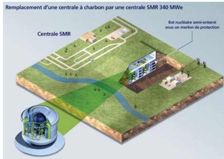
図 3.3-12 石炭火力発電プラントを 34 万 kW の SMR でリプレイスした場合のレイアウト
