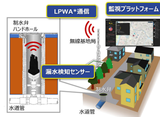
図表 7-2-21 「センサーを活用した漏水検知サービス」の技術概要
