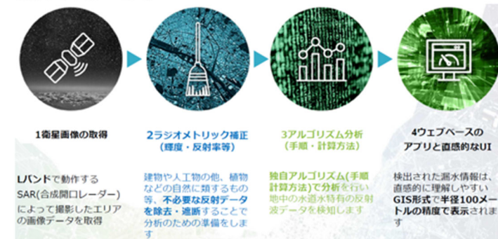
【漏水検知プロセス】
