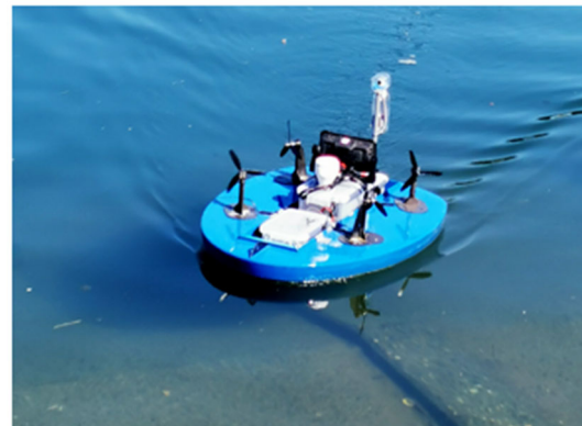
（ボート型のドローンを用いた点検）
