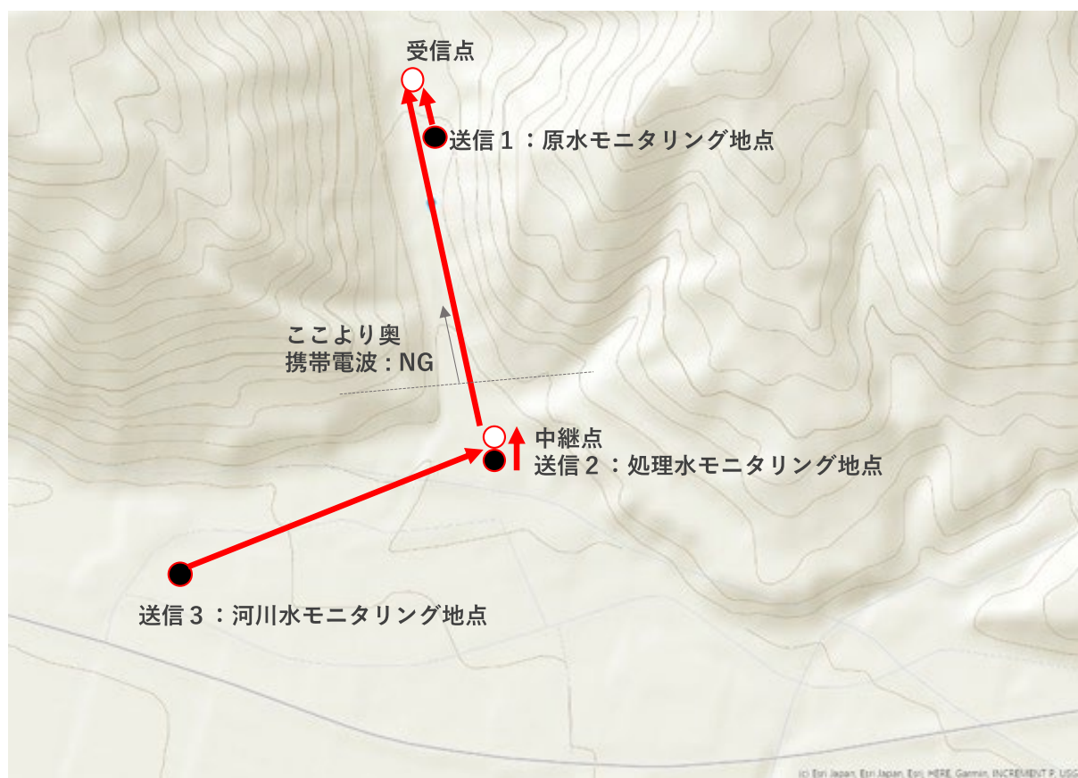
図 3-11 鉱山 B 遠隔監視システムネットワーク図
