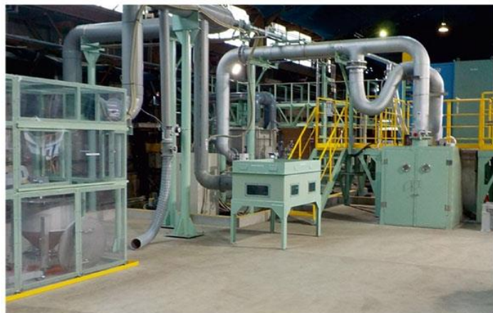
住友金属鉱山のLIBリサイクル実証用 乾式工程パイロットプラント
