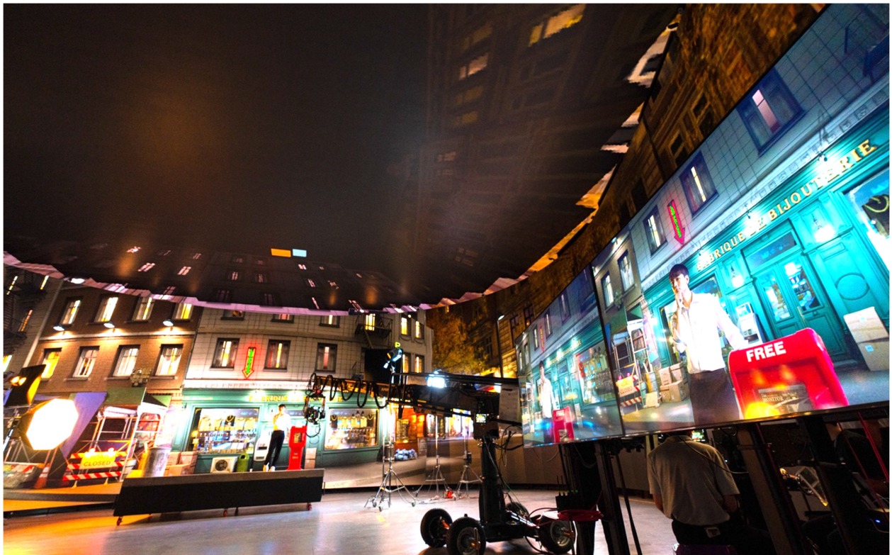
※LEDに映し出された背景は、リアルタイムで合成されて、モニター画面に映し出される (「CJ ENM」提供)
