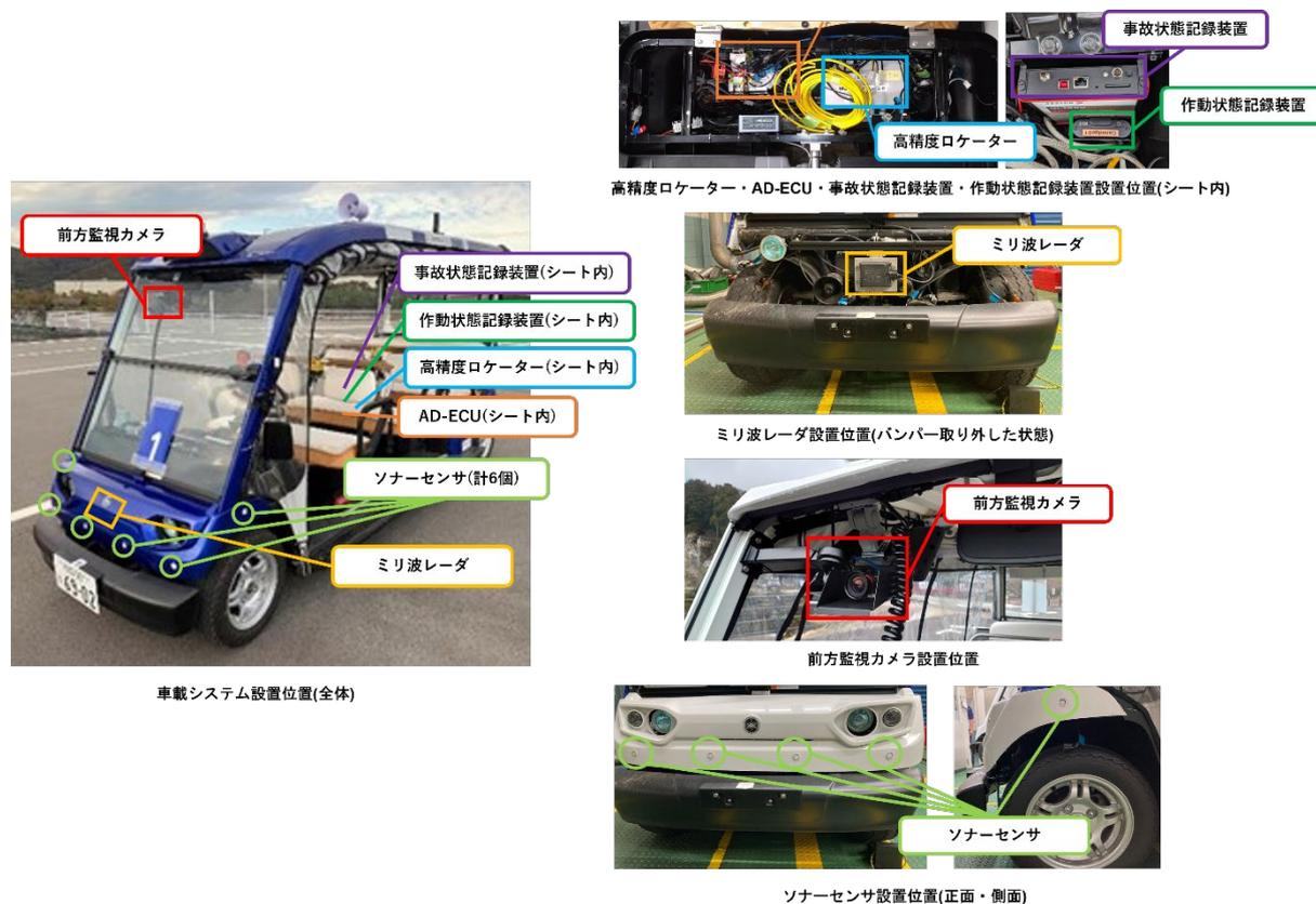
図 4.3.2-1 自動運転車載システム設置概要図
