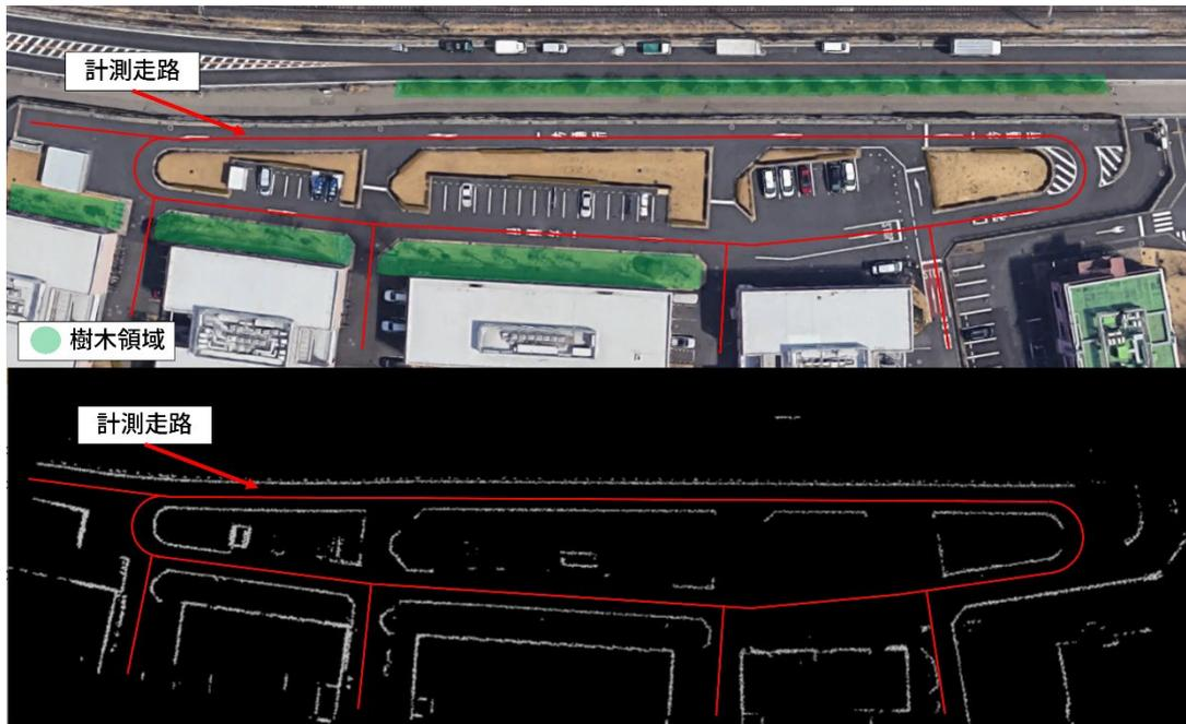
図 4.1.1-6 航空写真（Google Earth より）と高精度地図の全体図
