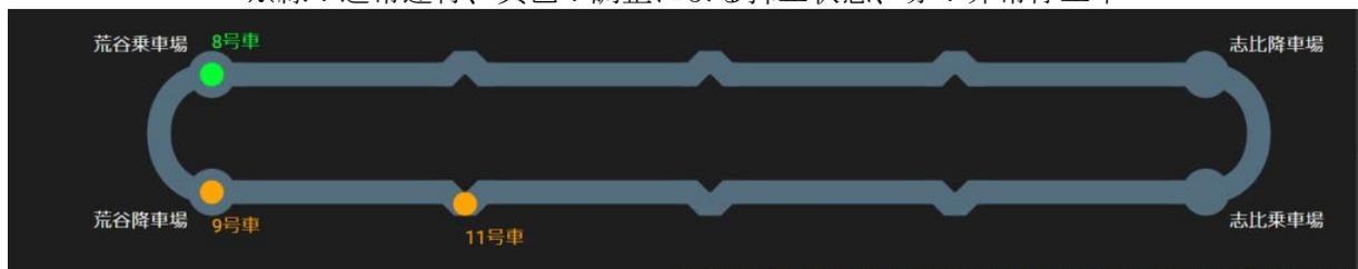
(b)8号車が乗車場に移動すると9号車が降車場に移動。11号車はひとつ前の待避所
