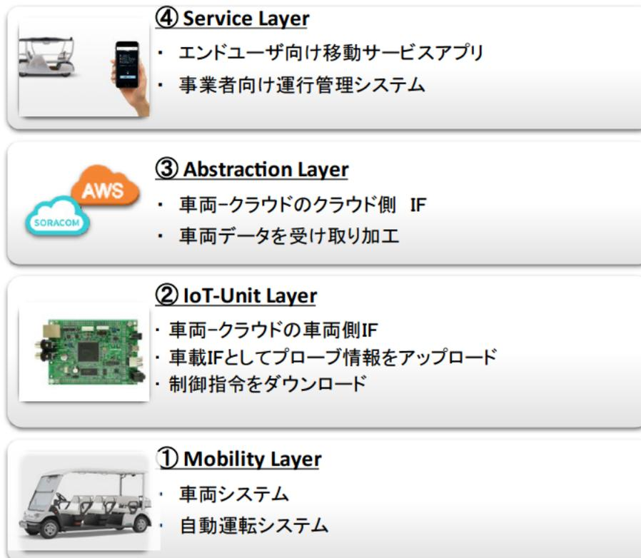
図 4.4.1.2-1 自動運転モビリティサービスの 4 層構造
