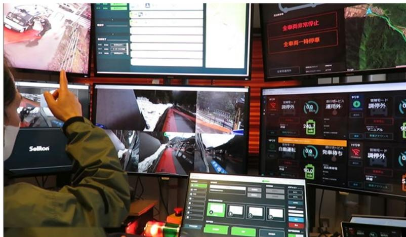
車両から、異常状態通知、または通話要求があると、警報とともにパトランプが点滅、遠隔オペレータは遠隔システムを利用して、当該車両の状況把握に努める（監視制御盤は令和3年度設計のもの）
