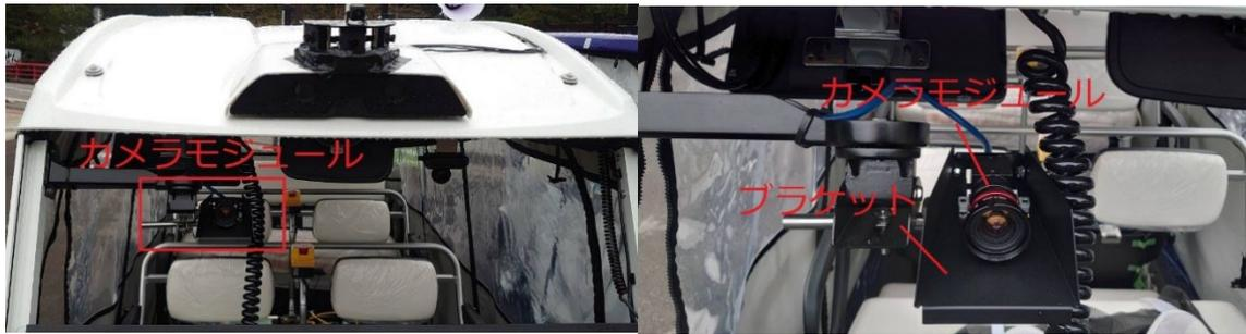
図 4.3.2.3.3-3 実証試験車両のカメラモジュール搭載写真
