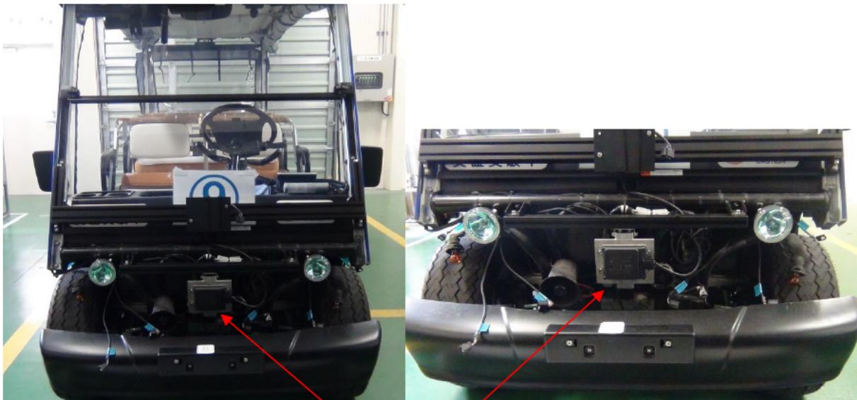
図 4.3.2.4.2-2 実証試験車両のミリ波レーダ搭載写真
