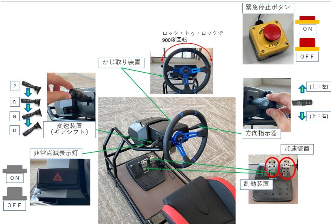
図 4. 4. 3. 1-19 遠隔操縦装置の操作、並びに緊急停止ボタンの操作
