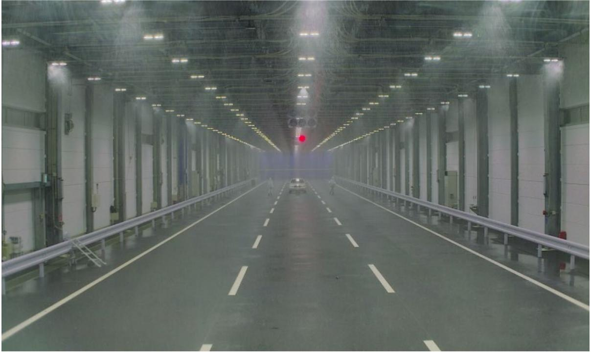
図 4-15 カメラ画像（雨量 50 [mm/h] : 距離 105[m]）
