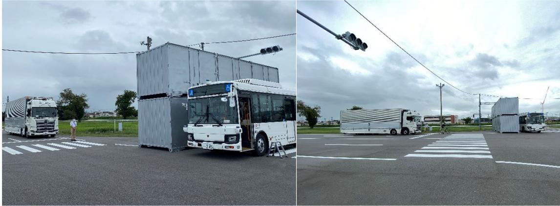
図 3-70 交差点側方認識試験（駐車車両有り） 設置方法・実施条件・風景
