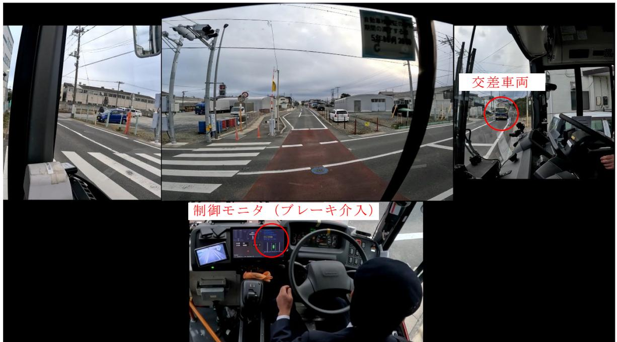
図 3-32 シーン抽出例：交差車両検出遅れによるブレーキ介入シーン
