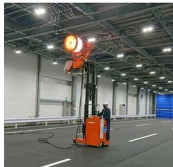
図 3-74 日照試験設備
