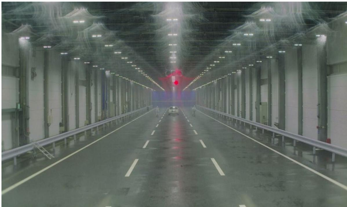
図 4-14 カメラ画像（雨量 30 [mm/h] : 距離 105[m]）
