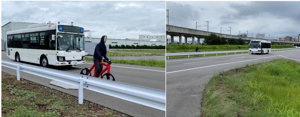
図 3-65 ガードレール周辺の自転車検知試験 設置方法・実施条件・風景
