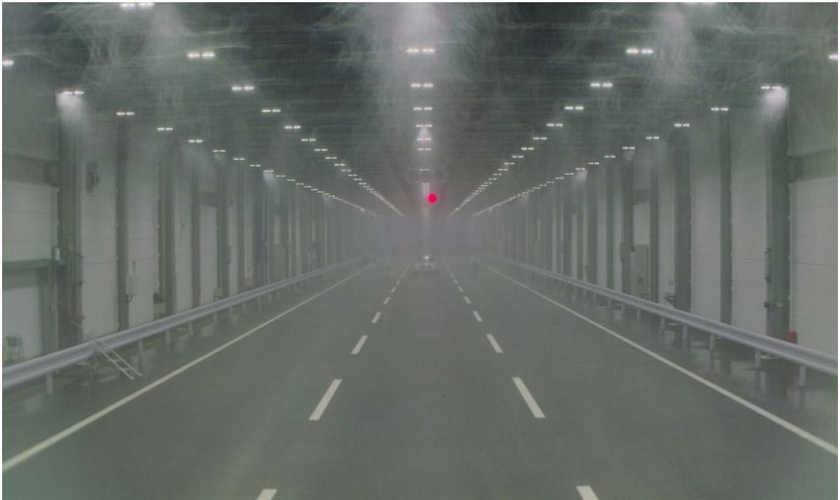
図 4-16 カメラ画像（雨量 80 [mm/h] : 距離 105[m]）
