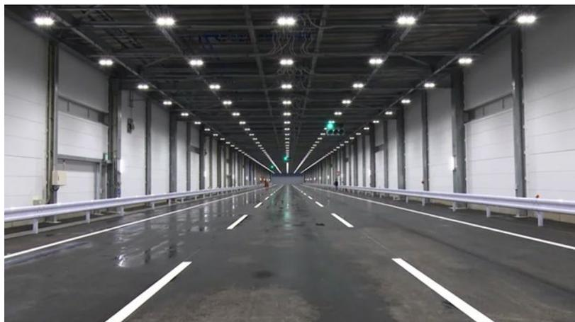
図 3-20 JARI 特異環境試験場（試験路全長 200m x 3 車線（3.5m））
