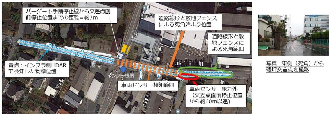
図 4-177 磯坪交差点 LiDAR ログデータと死角範囲
