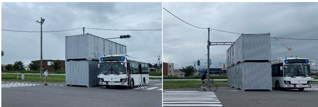
図 3-69 交差点側方検知試験（駐車車両無し） 設置方法・実施条件・風景
