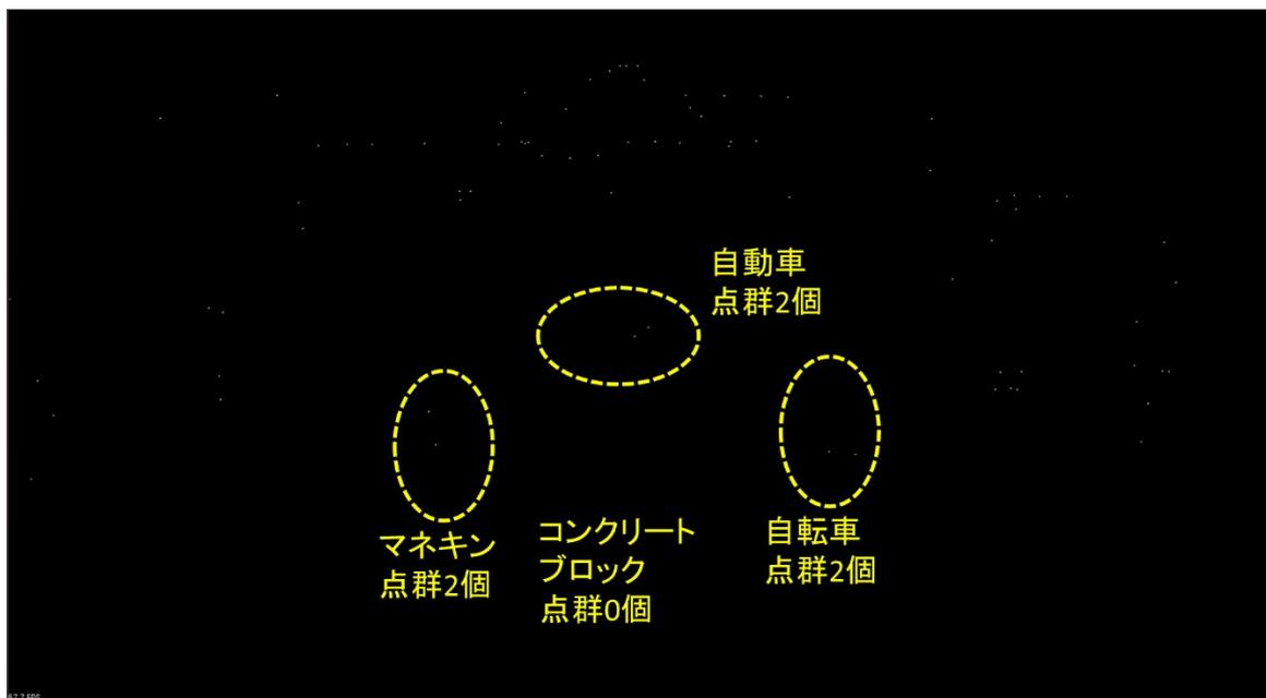
図 4-18 LiDAR 点群 (雨量 50 [mm/h] : 距離 105[m])
