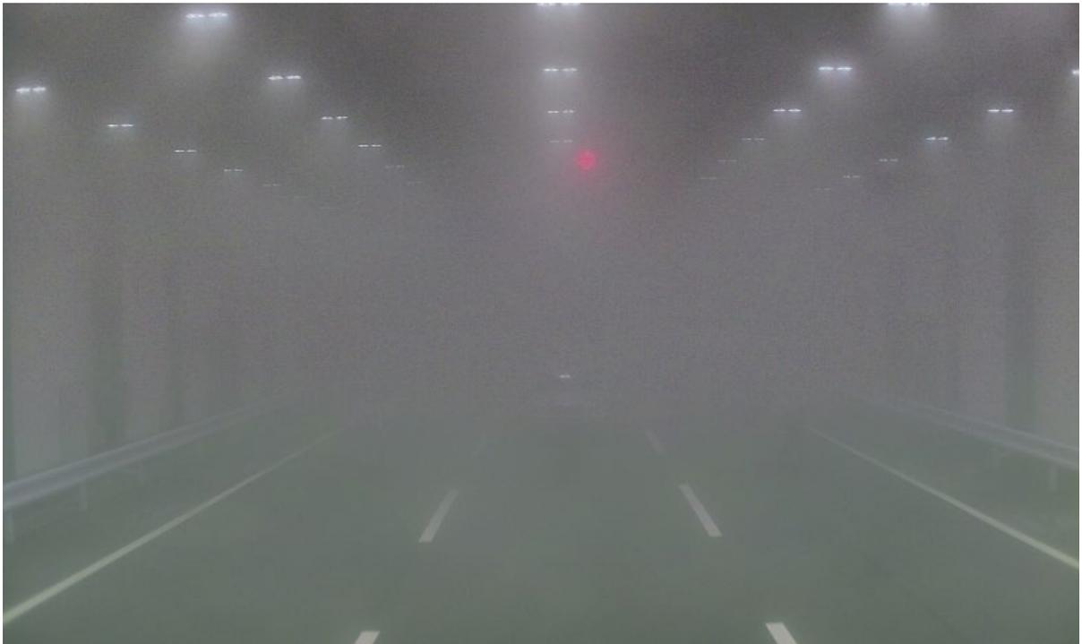
図 4-35 カメラ画像（視程距離 30 [m] : 距離 25[m]）
