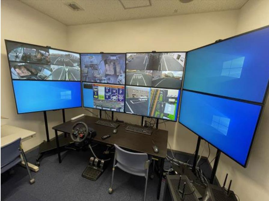
**図 5-17 遠隔監視・遠隔操作評価システム**
