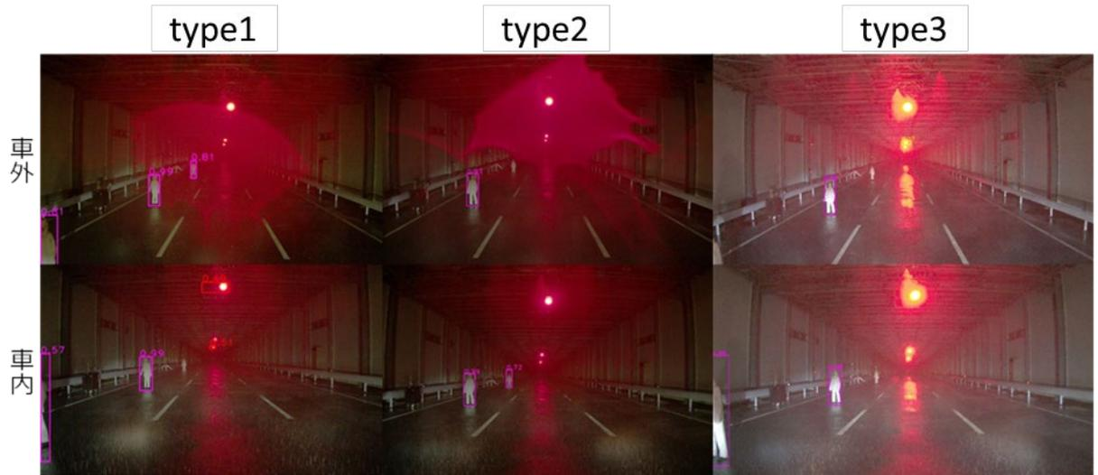
図 3-28 雨天シーン (0lx、雨量 50mm/h) 信号機 15・55m
