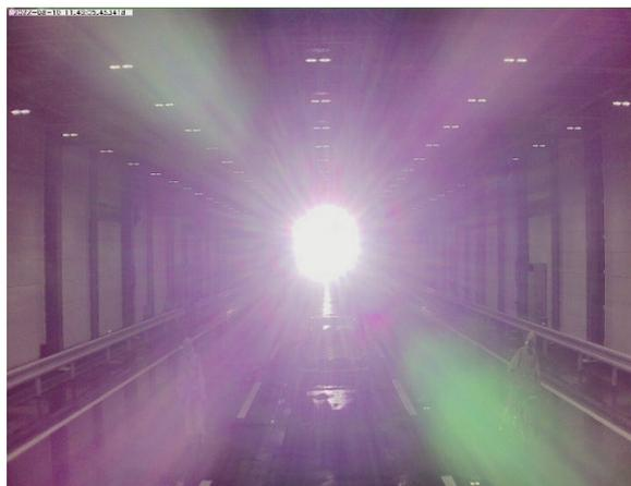
図 4-99 距離 15m 日照機が背景にあるときの信号用カメラの映像（信号機は青）
