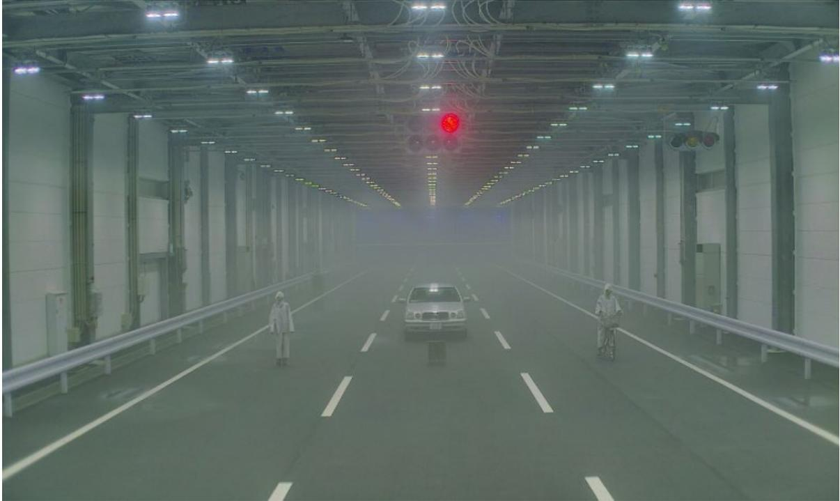
図 4-33 カメラ画像（視程距離 80 [m] : 距離 25[m]）
