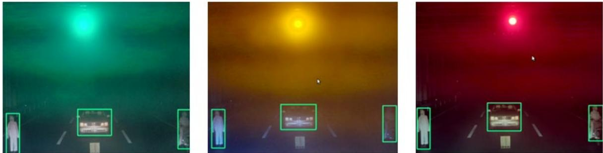
図 4-102 視程 80m 照度 0 lux 距離 15m でのカメラでの信号の見え方
