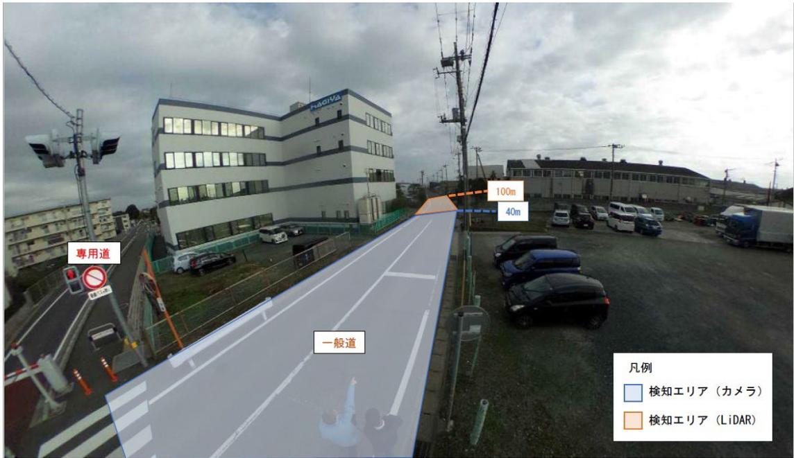
図 7-41 建柱位置から東向き of 想定検知エリア (カメラ高さ G.L.4.5m と仮定)
