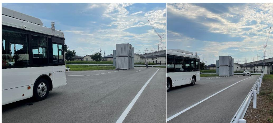
図 3-66 カーブ路の前方認識試験（車速 0km/h） 設置方法・実施条件・風景
