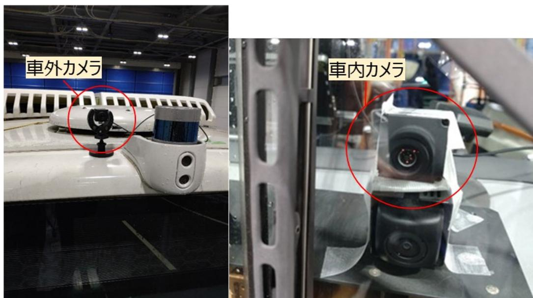
図 3-18 カメラ設置位置（左：車外カメラ、右：車内カメラ）
