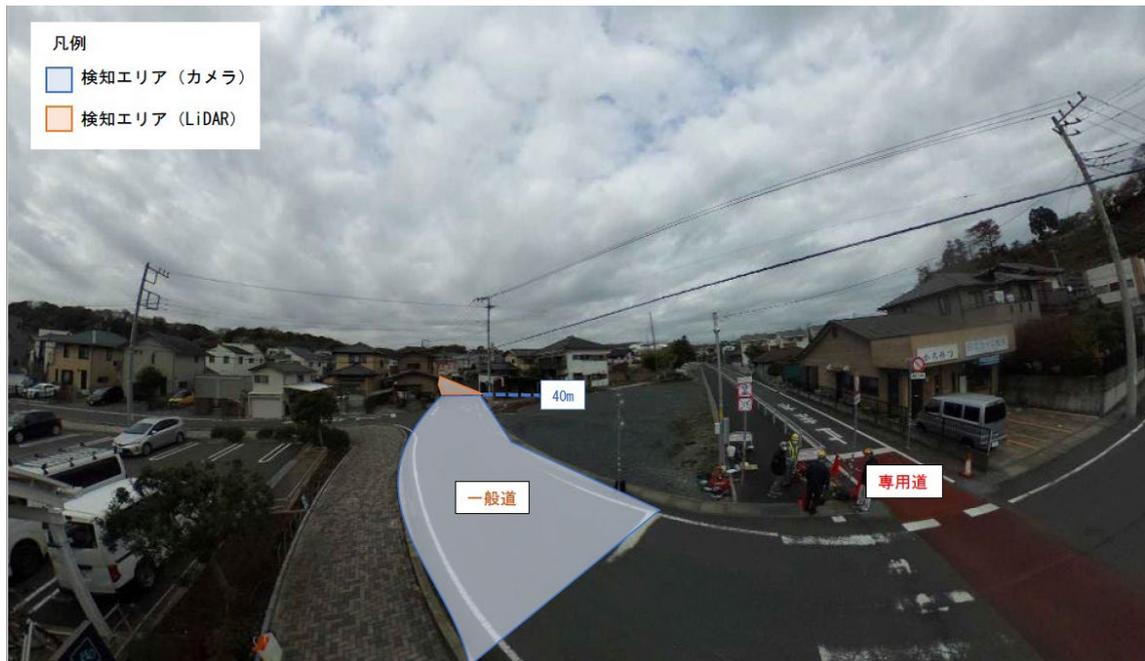
図 7-43 建柱位置から西向き of 想定検知エリア (カメラ高さ G.L.4.5m と仮定)
