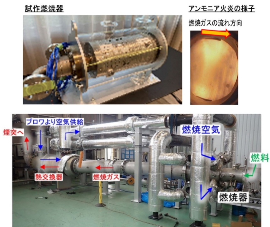
図 5.3-5 フルスケールアンモニアの燃焼試験装置
