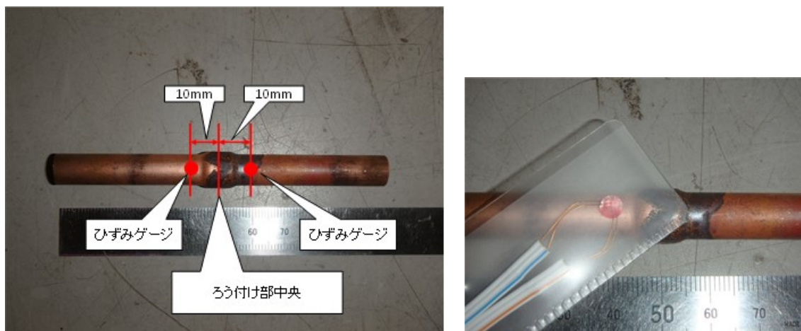
図8 ひずみゲージ貼付状況
