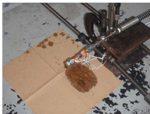
図 7 試験体破裂状況（代表）試験体：使用済み配管②
