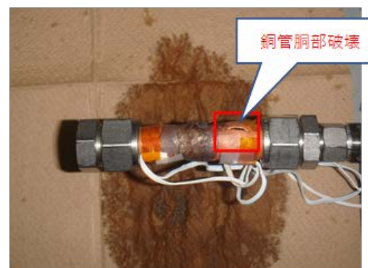
図 7 試験体破裂状況（代表）試験体：使用済み配管②
