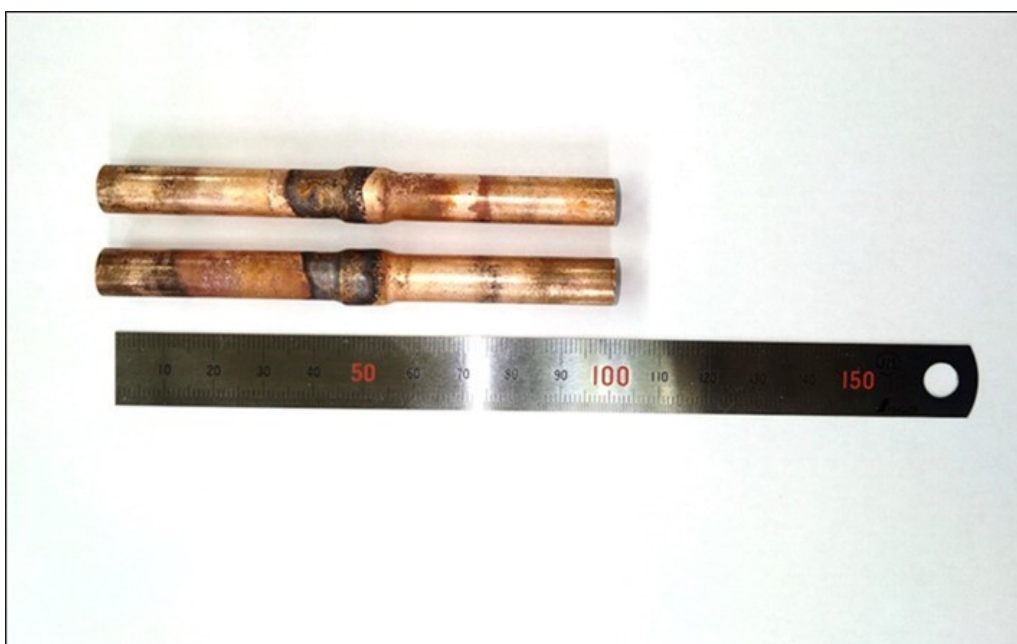
図 2 試験体完成写真
