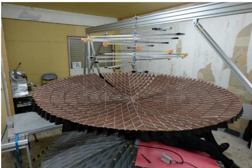
図 2-88  $\phi 2.5\text{m}$  扇子型展開式高精度反射鏡
