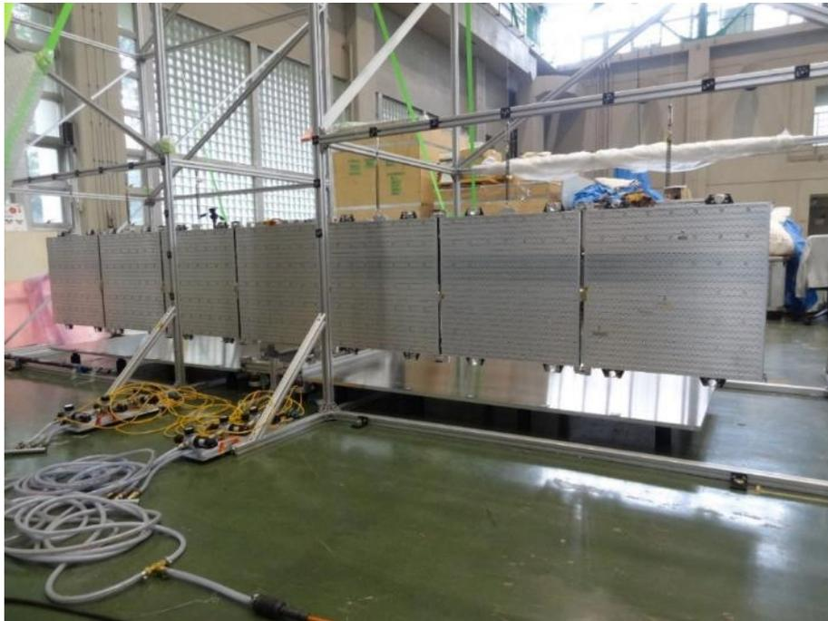
図 2-95 スロットアレイアンテナ
