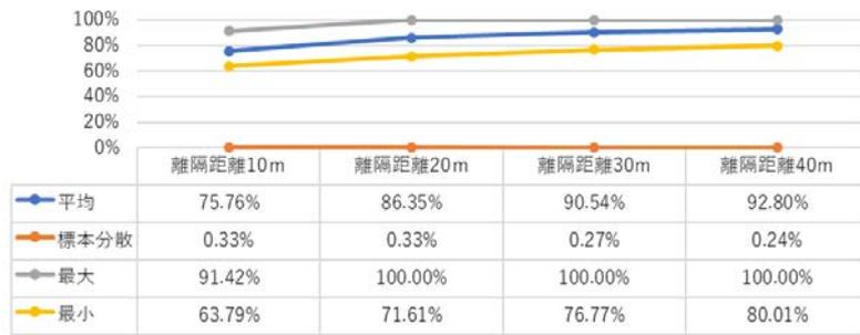
図 2-136 不統一配置パターンにおける離隔距離と発電効率の関係
