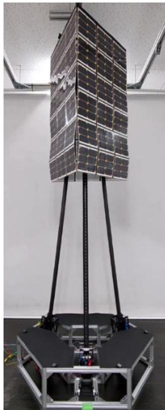
図 2-118 展開・収納機能を持つタワーのブレッド・ボード・モデル
