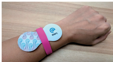
身につけると指がアンテナになり、 手で触れるだけで認証ができる
