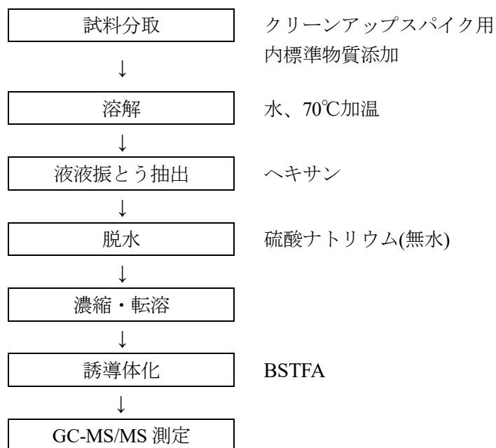
図 2-2 PCP 含有試験フローチャート(にかわ)
