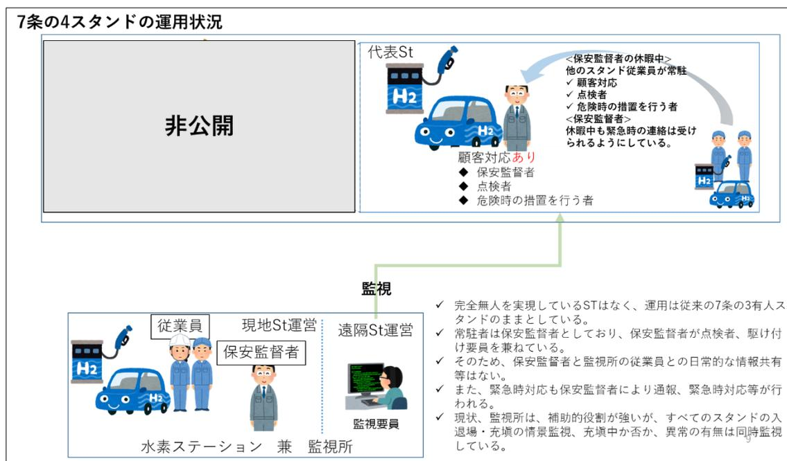
図 3.1-6 遠隔監視型圧縮水素スタンドの運用状況
