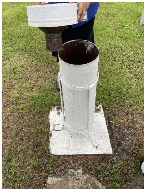
図 3.6 マニュアル式雨量計（PAGASA Davao City Synoptic 観測所）
