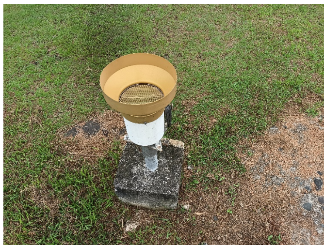
図 3.5 AWS 転倒マス型雨量計（PAGASA Davao City Synoptic 観測所）
