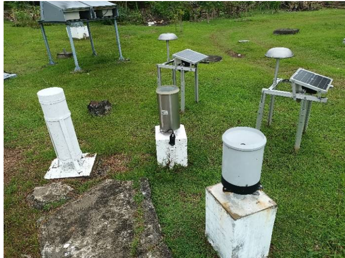
図 3.3 PAGASA Davao City Synoptic 観測所に設置された雨量計
