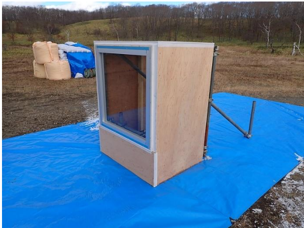
図 4.2.3.1-8 (写真 H) 実験 No.2-2 ガラス破壊状況 (65.0 m、換算距離 20.5) (割れなし)
