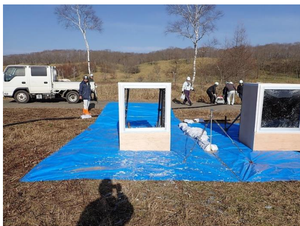
図 4.2.3.1-2 (写真 B) 実験 No.2-1 ガラス破壊状況 (25.5 m、換算距離 11.8)
