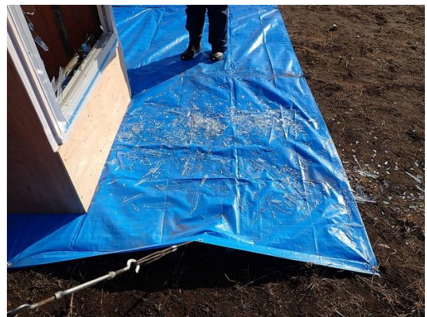
No.2-1 (No.1-3) 窓ガラス破壊状況 ④ 40.0 m フィルム無し
