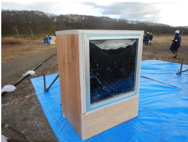
図 4.2.3.1-11 (写真 K) 実験 No.2-2 ガラス破壊状況 (40.0 m、換算距離 12.6)
