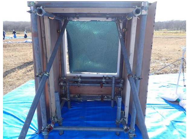
図 4.2.3.1-5 (写真 E) 実験 No.2-1 フィルム貼付ガラス破壊状況 (15.5 m、換算距離 7.2)
