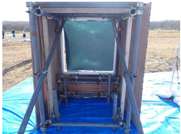
No.2-1 (No.1-3) 窓ガラス破壊状況 ②15.5 m 左：フィルム無し、右：フィルム有り
