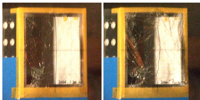
図 5.A.1-5 室内実験で撮影されたガラス破損状況（背面オープン、C4 3 g 距離 1.7 m）
