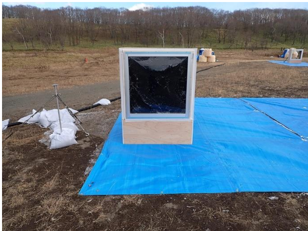
No.2-2 (No.1-4) 窓ガラス破壊状況 ②40.0 m フィルム有り
