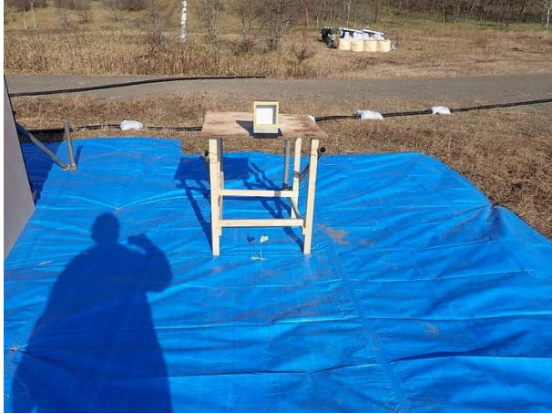
図 4.2.3.1-7 (写真 G) 実験 No.2-1 小型ガラス破壊状況 (割れなし) (左 : 25.5 m 地点、右 40.0 m 地点)
