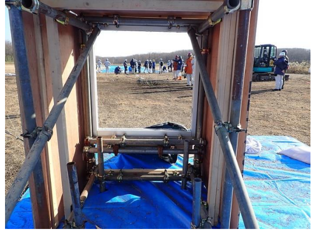
図 4.2.3.1-4 (写真 D) 実験 No.2-1 フィルム貼付ガラス破壊状況 (10.8 m、換算距離 5)
