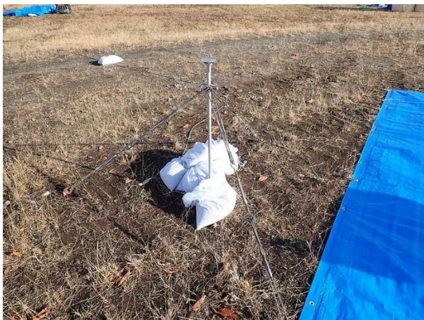
爆風計測架台
