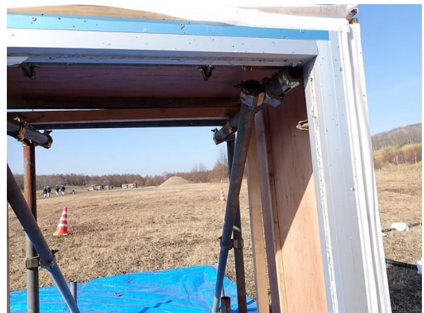
No.2-1 (No.1-3) 窓ガラス破壊状況 ①10.8 m フィルム有り
