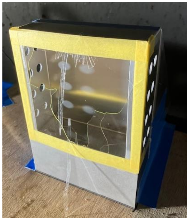
図 5-6 実験 No.R3 (C4 爆薬 14.5g 距離 2.8 m ( K=9.56 )) ガラスの破損状況
