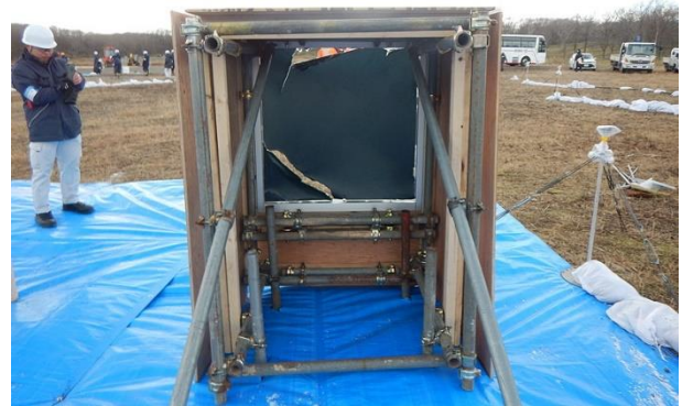
図 4.2.3.1-10 (写真 J) 実験 No.2-2 ガラス破壊状況 (25.5 m、換算距離 8.0)
