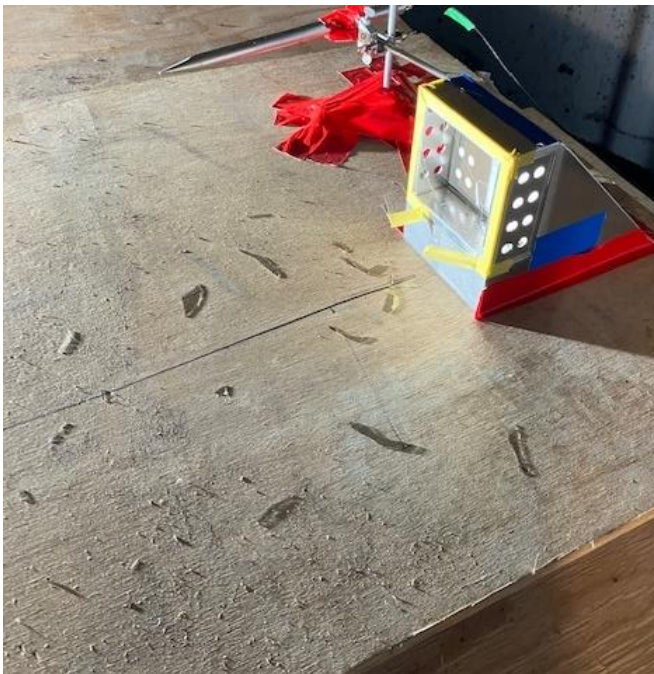
図 5-12 実験 No.R5 (C4 爆薬 7 g 距離 2.26 m ( K=9.84 )) ガラス破片の飛散状況
