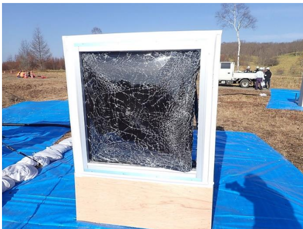
No.2-1 (No.1-3) 窓ガラス破壊状況 ②15.5 m 左：フィルム無し、右：フィルム有り
