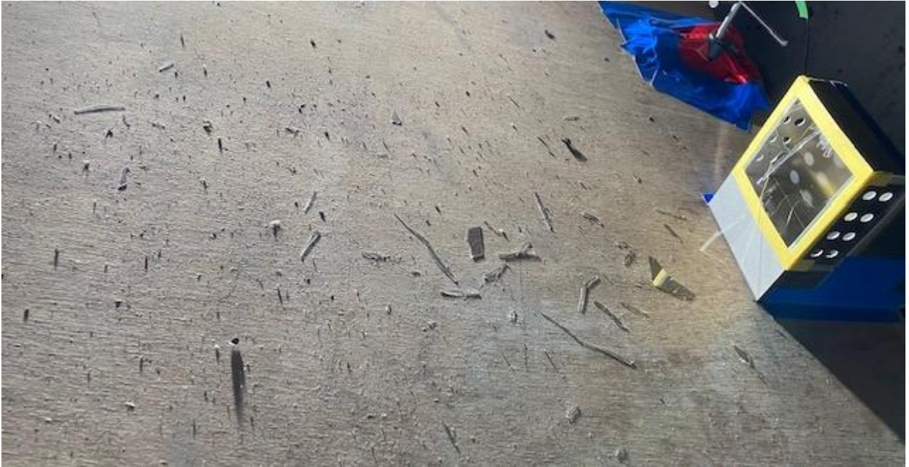
図 5-11 実験 No.R3 (C4 爆薬 14.5g 距離 2.8 m ( K=9.56 )) ガラス破片の飛散状況
