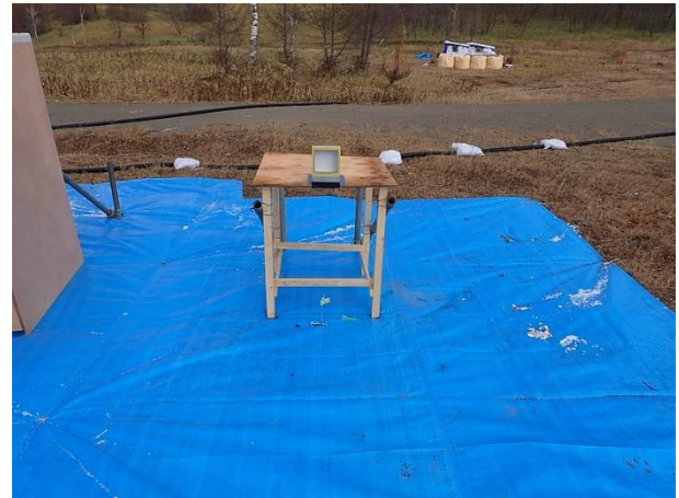
No.2-2 (No.1-4) 窓ガラス破壊状況 ①25.5 m フィルム有り
