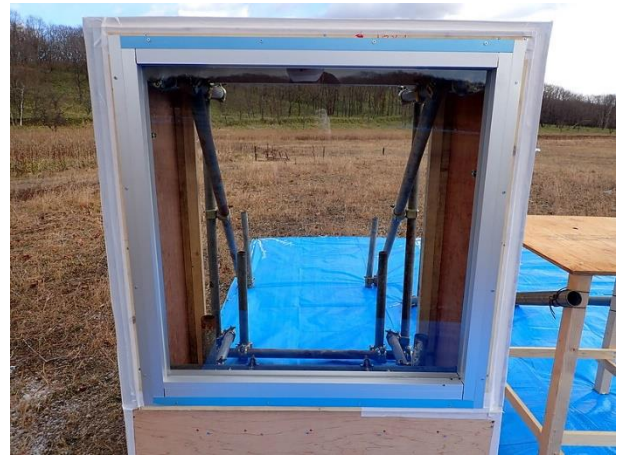
No.2-2 (No.1-4) 窓ガラス破壊状況 ④90.0 m フィルム無し、小型ガラス
