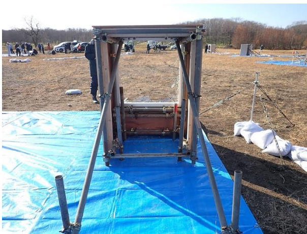
No.2-1 (No.1-3) 窓ガラス破壊状況 ④ 40.0 m フィルム無し
