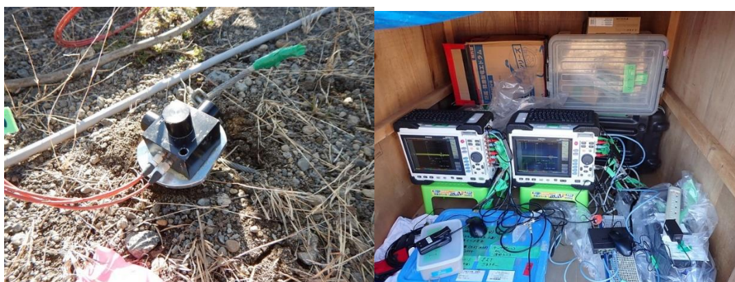
図 4.1.2.3-6 地盤振動計の設置状況と計測ボックス内の地盤振動計測機器
