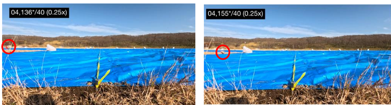
図 4.1.3.3-2 飛散物解析結果 ( 実験 No.1-3 爆点から 60 m 地点での飛散物挙動、4.136 秒と 4.155 秒)
