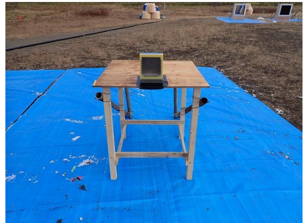
No.2-2 (No.1-4) 窓ガラス破壊状況 ②40.0 m フィルム有り
