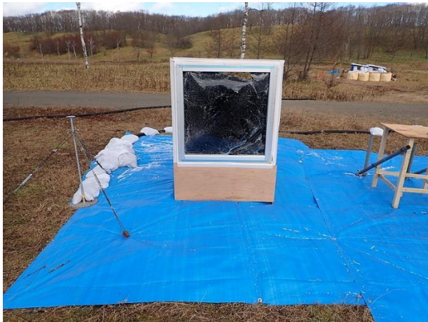
No.2-2 (No.1-4) 窓ガラス破壊状況 ①25.5 m フィルム有り
