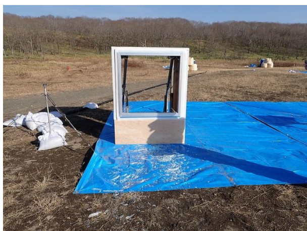
図 4.2.3.1-3 (写真 C) 実験 No.2-1 ガラス破壊状況 (40.0 m、換算距離 18.6)
