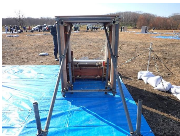
図 4.2.3.1-3 (写真 C) 実験 No.2-1 ガラス破壊状況 (40.0 m、換算距離 18.6)
