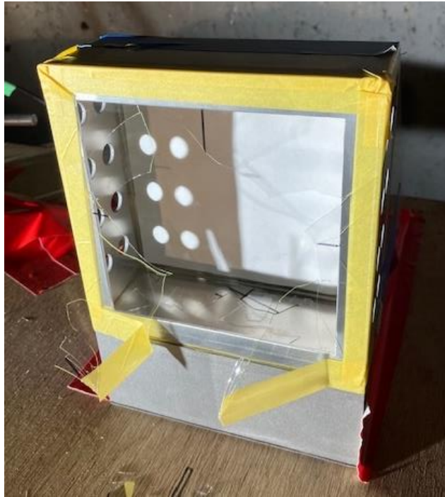
図 5-7 実験 No.R5（C4 爆薬 7 g 距離 2.26 m（K=9.84））ガラスの破損状況
