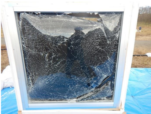
図 4.2.3.1-10 (写真 J) 実験 No.2-2 ガラス破壊状況 (25.5 m、換算距離 8.0)
