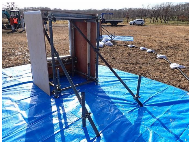
図 4.2.3.1-1 (写真 A) 実験 No.2-1 ガラス破壊状況 (15.5 m、換算距離 7.2)
