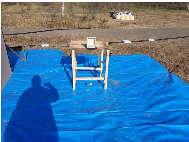
No.2-1 (No.1-3) 窓ガラス破壊状況 ④ 40.0 m 小型ガラス
