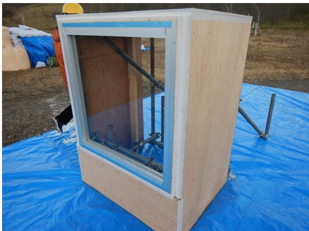
図 4.2.3.1-9 (写真 I) 実験 No.2-2 ガラス破壊状況 (90.0 m、換算距離 28.3) (割れなし)
