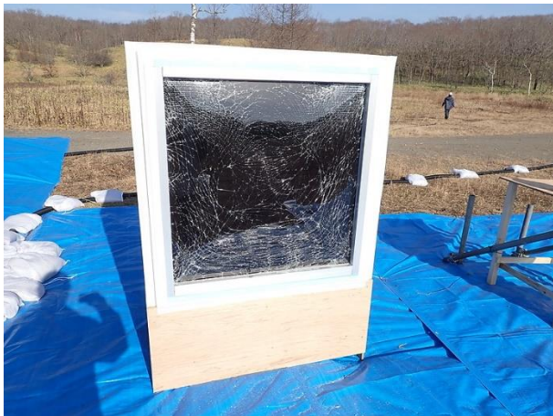
図 4.2.3.1-6 (写真 F) 実験 No.2-1 フィルム貼付ガラス破壊状況 (25.5 m、換算距離 11.8)
