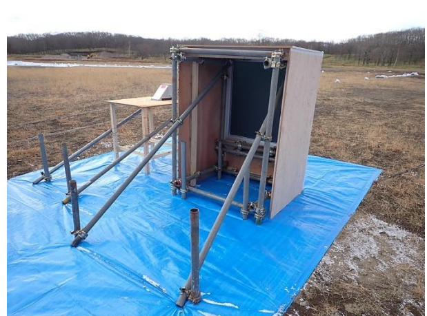
図 4.2.3.1-12 (写真 L) 実験 No.2-2 ガラス破壊状況 (65.0 m、換算距離 20.5) (割れなし)
