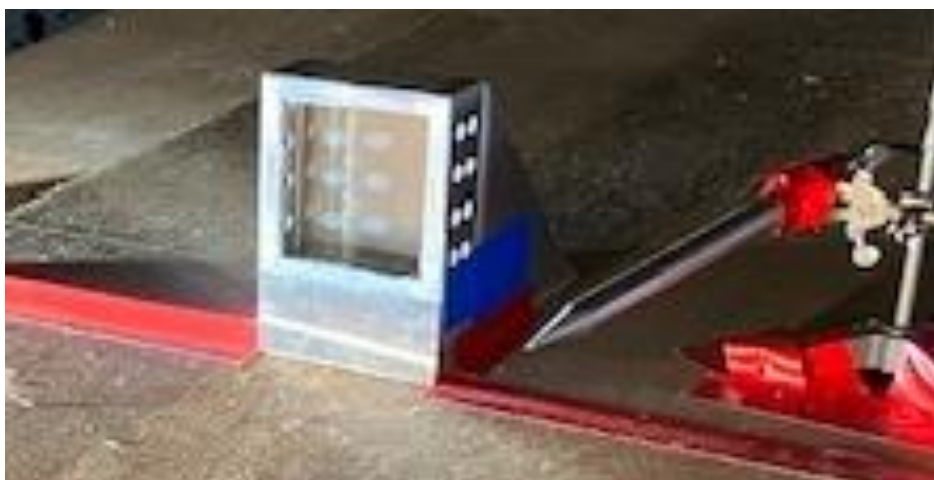
図 5-4 実験 No.R1 (C4 爆薬 23.7g 距離 1.5m ( K=4.35 )) ガラスの破損状況
