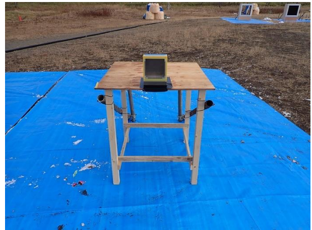
図 4.2.3.1-13 (写真 M) 実験 No.2-2 小型ガラス破壊状況 (左 : 25.5 m 地点、右 40.0 m 地点) (割れなし)
