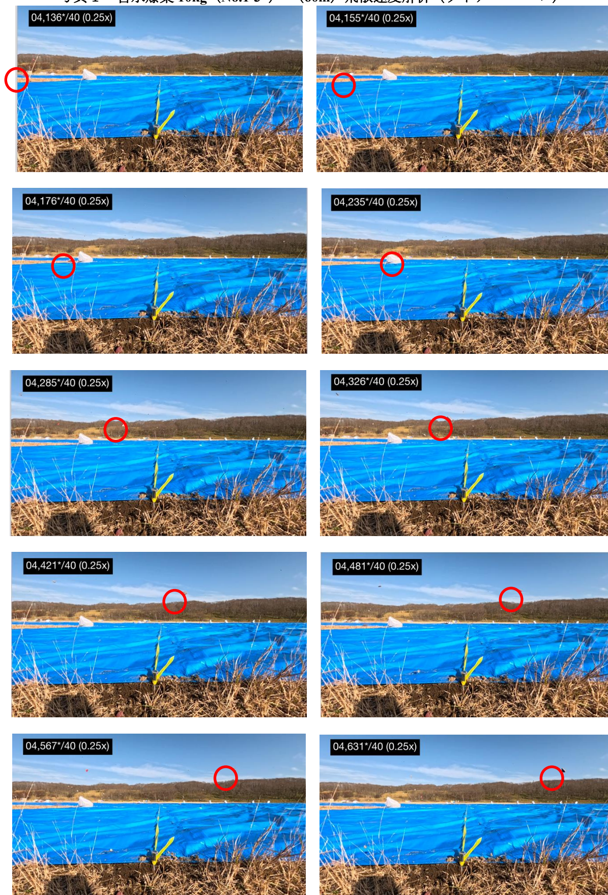
写真1 含水爆薬 10kg (No.1-3 ) (60m) 飛散速度解析 (ライナー →ゴロ)
