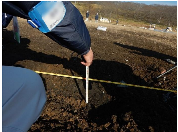
図 4.1.3.1-3 漏斗孔の写真 実験 No.1-3
