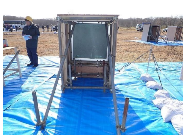
図 4.2.3.1-6 (写真 F) 実験 No.2-1 フィルム貼付ガラス破壊状況 (25.5 m、換算距離 11.8)
