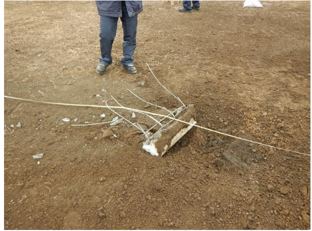
図 4.1.3.1-2 漏斗孔の写真 実験 No.1-2
