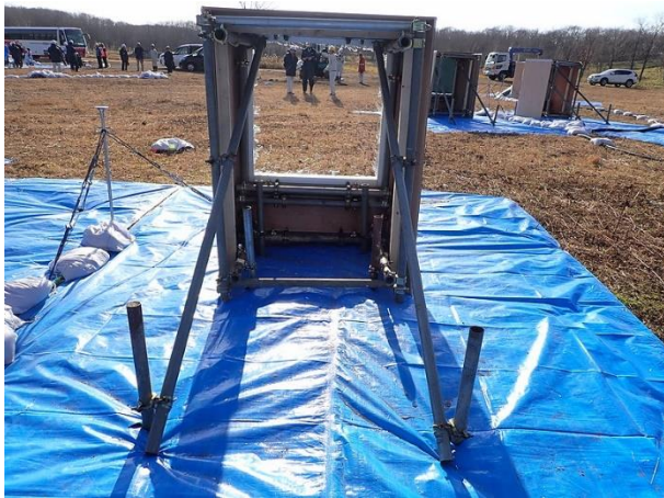
No.2-1 (No.1-3) 窓ガラス破壊状況 ③25.5 m 左：フィルム無し、右：フィルム有り
