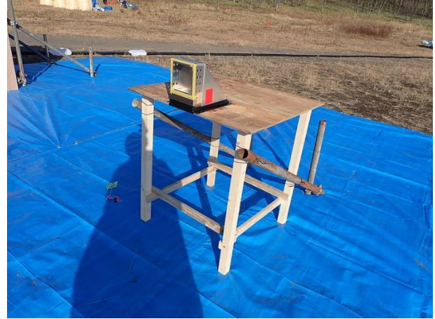
図 4.2.3.1-7 (写真 G) 実験 No.2-1 小型ガラス破壊状況 (割れなし) (左 : 25.5 m 地点、右 40.0 m 地点)
