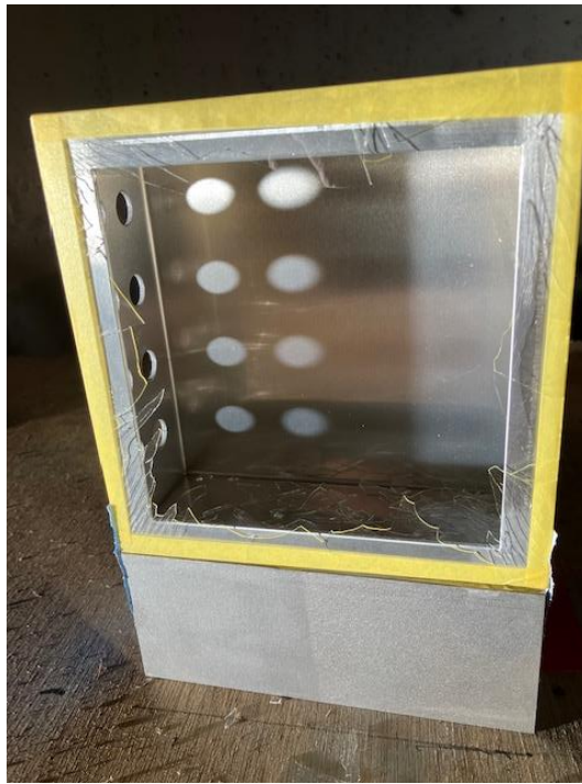
図 5-5 実験 No.R2 (C4 爆薬 23.7g 距離 2.78 m ( K=8.06 )) ガラスの破損状況
