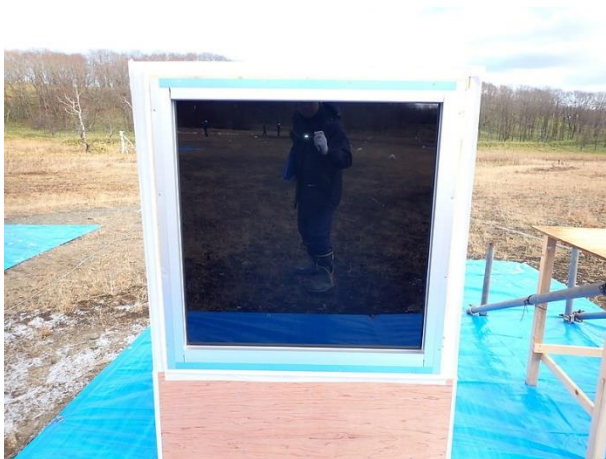
図 4.2.3.1-12 (写真 L) 実験 No.2-2 ガラス破壊状況 (65.0 m、換算距離 20.5) (割れなし)
