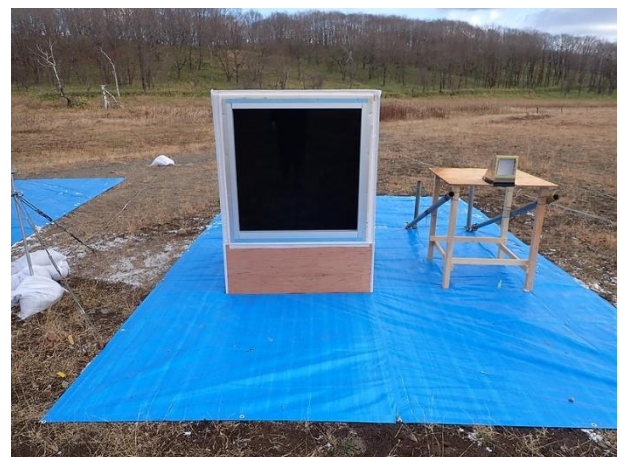
No.2-2 (No.1-4) 窓ガラス破壊状況 ③65.0 m 左フィルム無し、右フィルム有り
