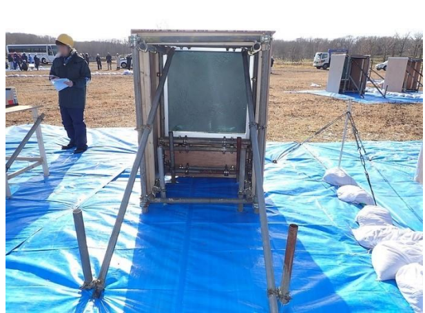
No.2-1 (No.1-3) 窓ガラス破壊状況 ③25.5 m 左：フィルム無し、右：フィルム有り
