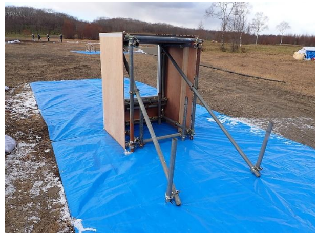
図 4.2.3.1-8 (写真 H) 実験 No.2-2 ガラス破壊状況 (65.0 m、換算距離 20.5) (割れなし)
