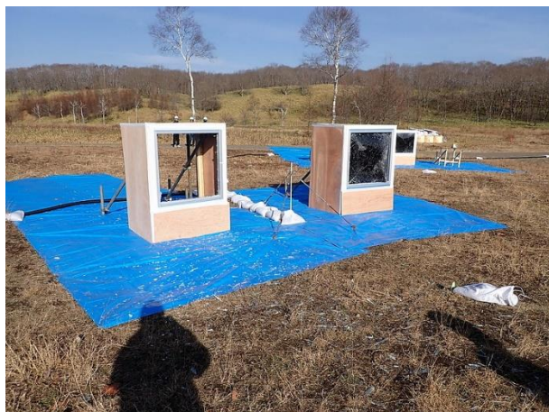
図 4.2.3.1-1 (写真 A) 実験 No.2-1 ガラス破壊状況 (15.5 m、換算距離 7.2)
