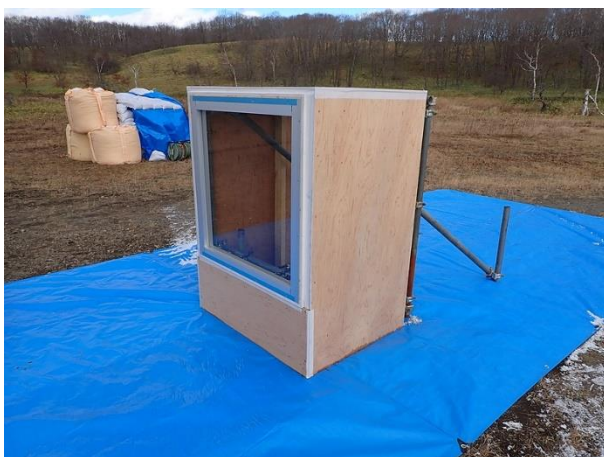
No.2-2 (No.1-4) 窓ガラス破壊状況 ③65.0 m 左フィルム無し、右フィルム有り
