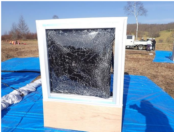
図 4.2.3.1-5 (写真 E) 実験 No.2-1 フィルム貼付ガラス破壊状況 (15.5 m、換算距離 7.2)
