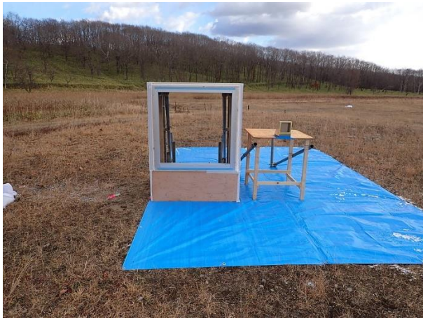
No.2-2 (No.1-4) 窓ガラス破壊状況 ④90.0 m フィルム無し、小型ガラス
