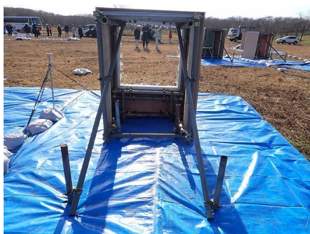
図 4.2.3.1-2 (写真 B) 実験 No.2-1 ガラス破壊状況 (25.5 m、換算距離 11.8)
