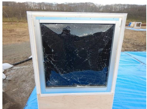
図 4.2.3.1-11 (写真 K) 実験 No.2-2 ガラス破壊状況 (40.0 m、換算距離 12.6)
