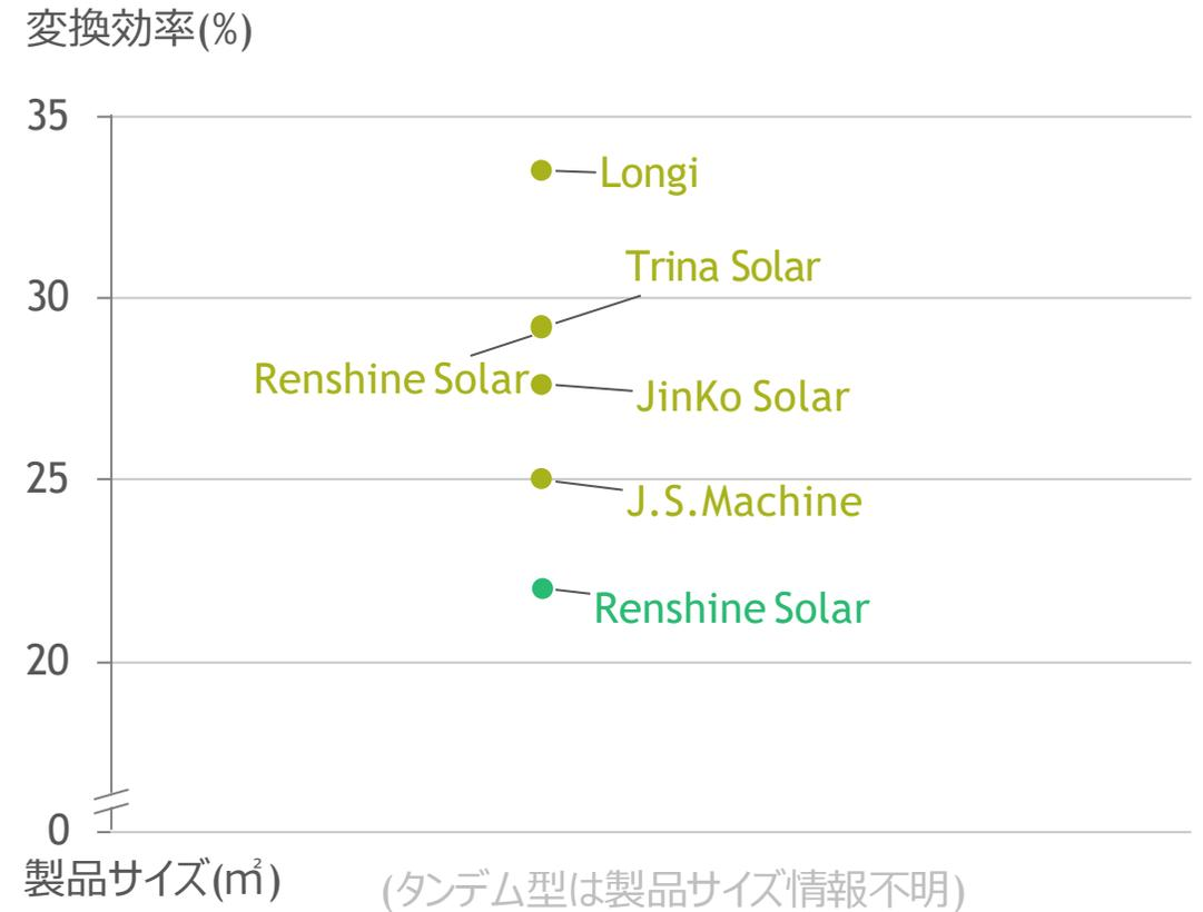
(参考)商用化されている従来型シリコン太陽電池の変換効率は14~20%でシリコン太陽電池の理論上の限界変換効率は29%(NEDOより)
