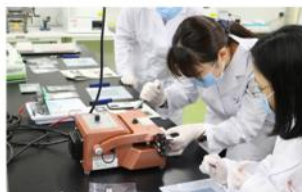
熱溶着してラミネートセルに
