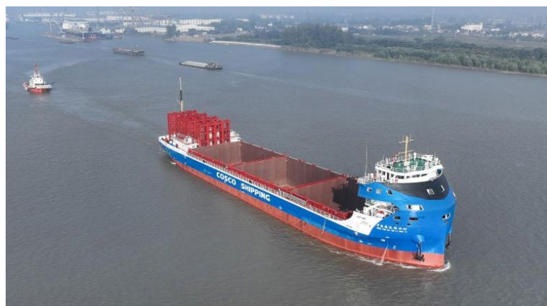
図 6.3-4 中国内航コンテナ船（完全電動）
