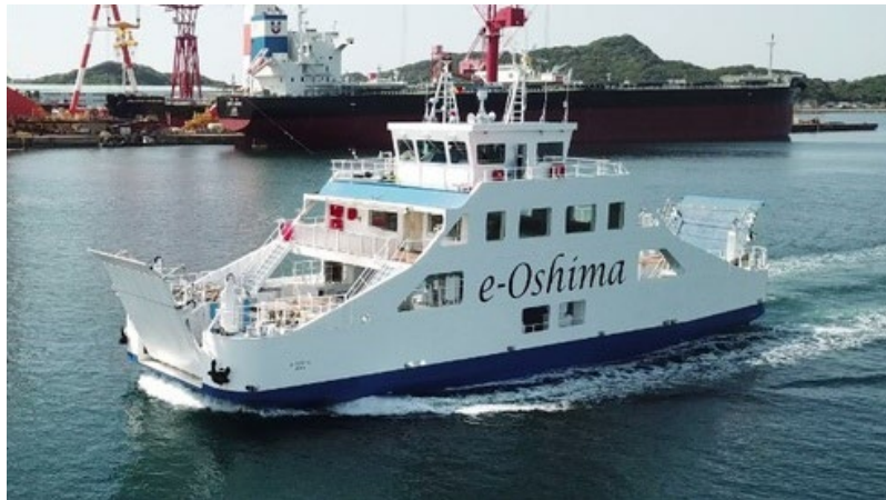
図 6.3-3 e-Oshima（完全電動）
