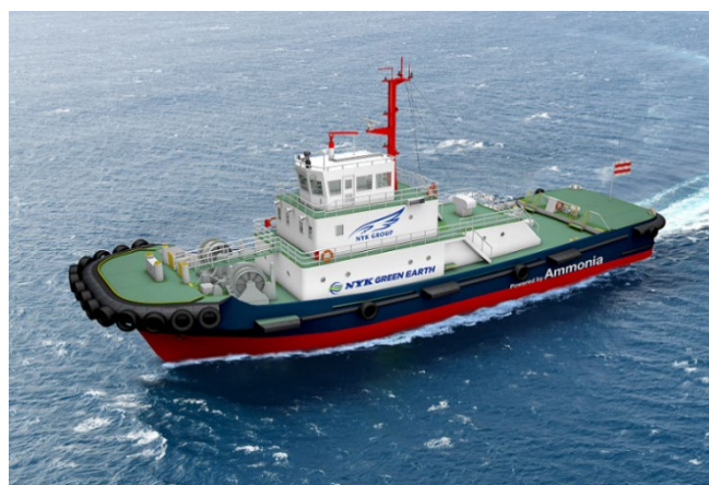
図 6.3-9 魁 (LNG 混焼⇒アンモニア専焼へ改造中)
