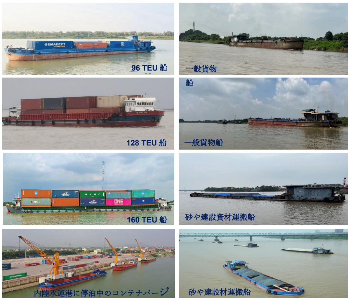
図 3.1-1 ベトナム北部で運用されている内陸水運バージ
