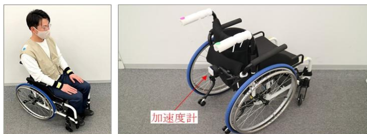
図 26 マーキング及び加速度センサの取付（実験者での再現）
