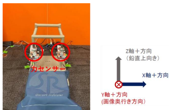
図 47 荷重センサの力の方向説明図
