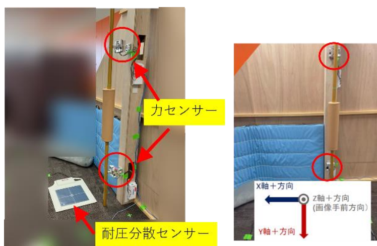
図36 縦型手すり用の実験装置と軸方向の例
