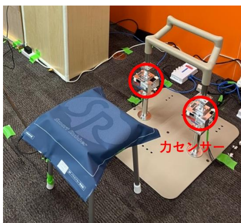
図 42 据置型手すりの実験装置例
