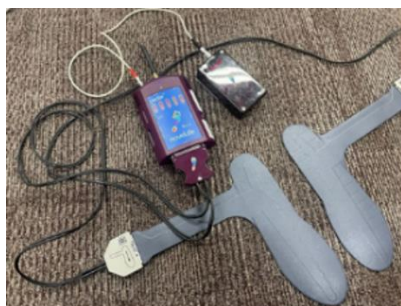
図7 足圧センサ機材（左）とビューワ表示例（右）
