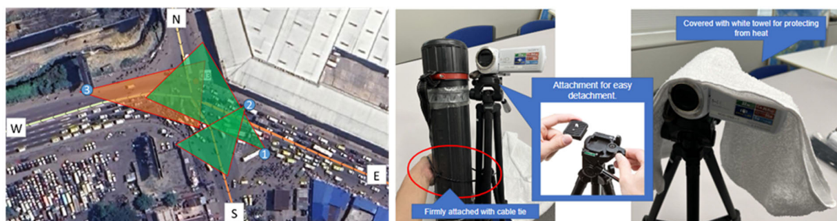
図 4.2.1 ビデオカメラの設置イメージと設置方法
