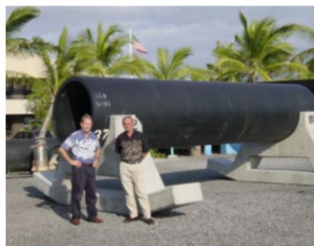
図 67 ハワイ NELHA で使用した HDPE 管 （実測 外径 140cm 厚さ 8cm）
