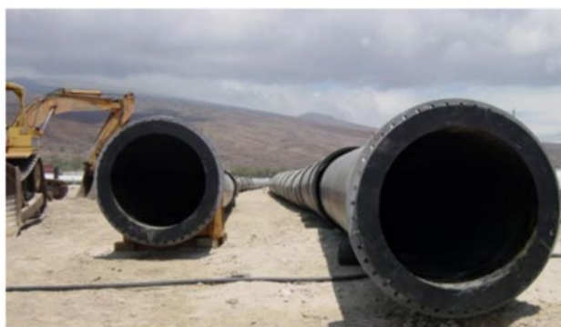
図 67 ハワイ NELHA で使用した HDPE 管 （実測 外径 140cm 厚さ 8cm）
