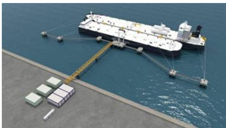
図 11 圧縮水素運搬船 (H2Neo) 及び浮体式保管庫 (H2Leo) 出所 : Provaris Energy
