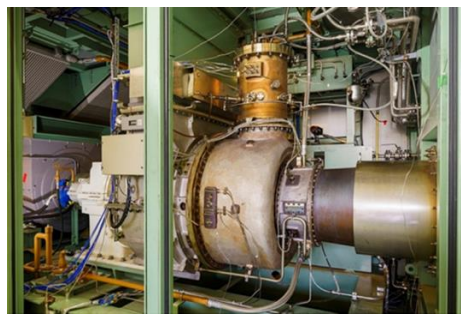
図 3 2MW 級ガスタービン（液体アンモニア燃焼）
