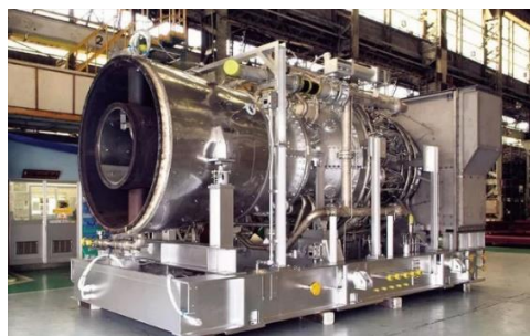
図 4 H-25 シリーズガスタービン（出力 40MW 級）
