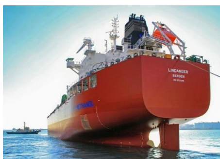
図 8 世界初の二元燃料、メタノール対応タンカー 出所: DNV
