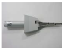
JIS C 62368-1の図 V.1のプロー ブ
