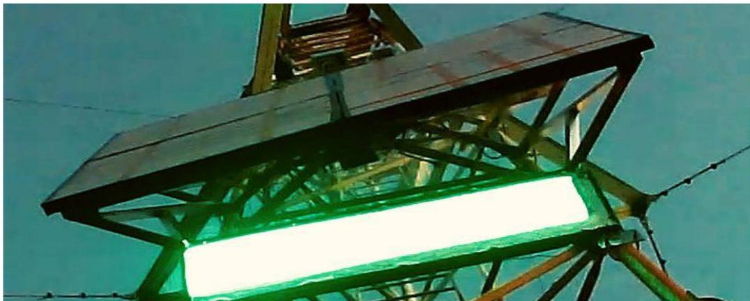
図 3-40 MIT の HUSIR 送信機を用いて実施されたマイクロ波送電による LED 点灯実験(Credit : NRL)
