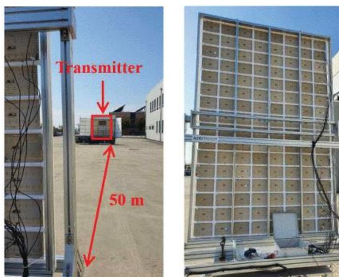
図 3-49 KERI における拡張可能なアレイ型レクテナの屋外実験
