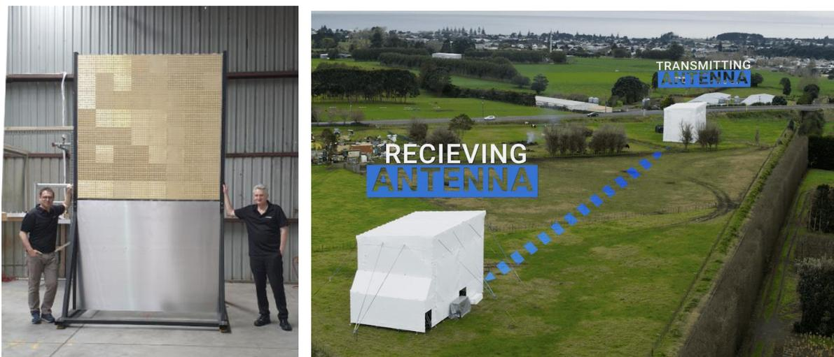
図 3-47 屋内試験のプロトタイプアンテナ(左)/フィールド試験の建屋(右)(Credit:Emrod)
