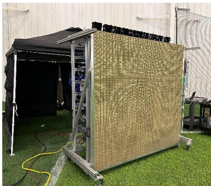
図 3-42 WPT 実験に用いられた送信アンテナのプロトタイプ
