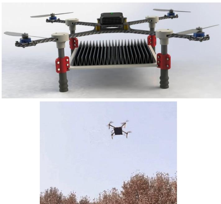
図 3-52 中国西北工業大学が開発した ODD (Optics-driven Drone)と飛行試験の様子
