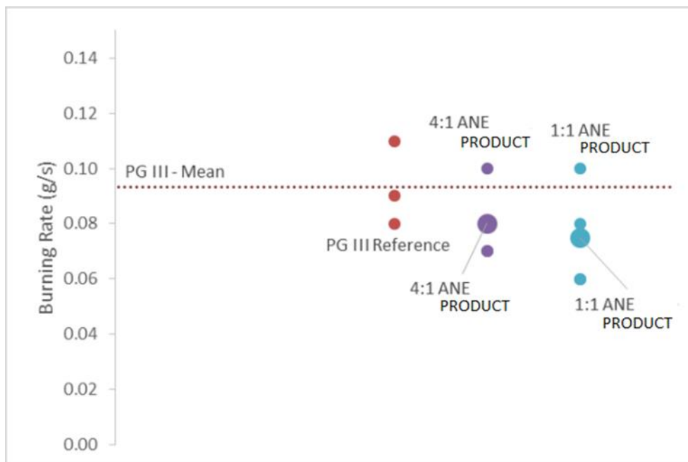
図 2: 3 つの容器等級のリファレンス混合物と 2 つの ANE 製品混合物について計算された燃焼速度と平均。この ANE 製品の平均結果は PGIII の指定を下回っており、非 5.1 区分として分類できる。
