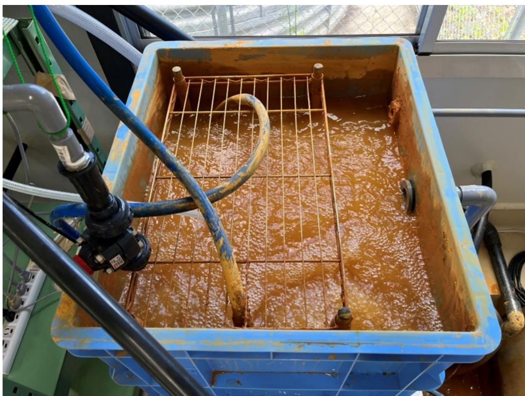
図 2.5-23 現地パイロット試験に使用した曝気槽
