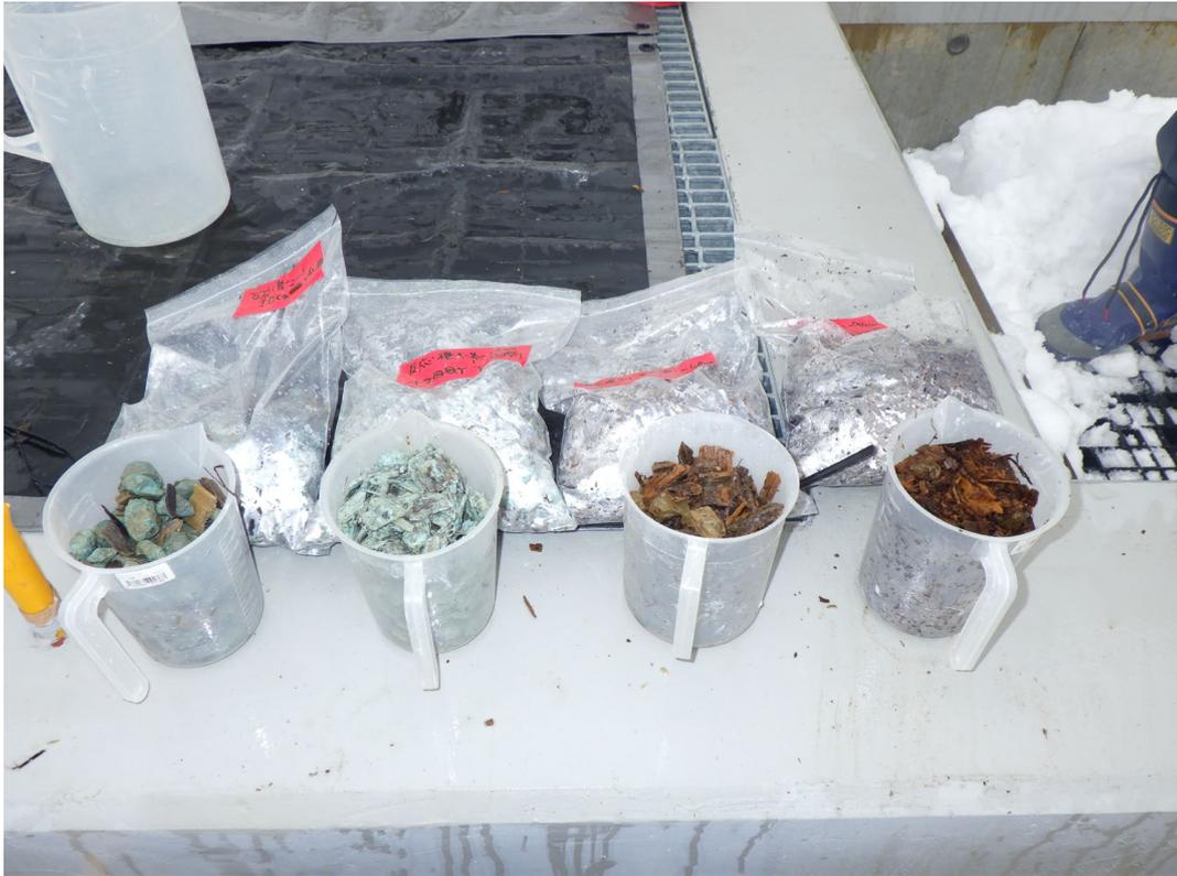
図 2.6-30 反応槽 1 の深度別サンプル (洗浄前)
