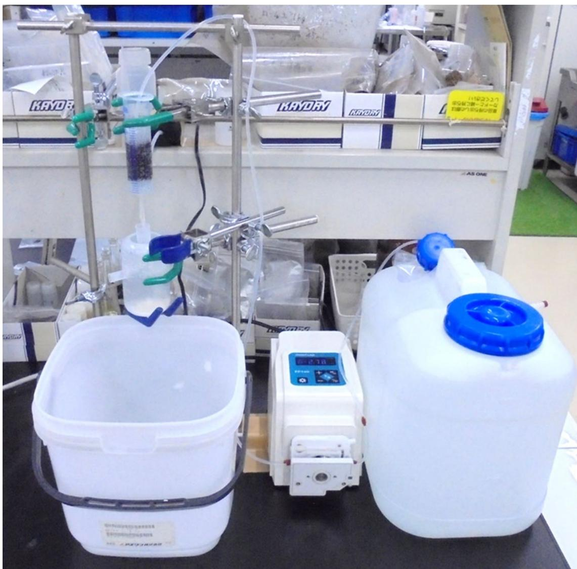
図 2.5-12 室内通水試験の様子
