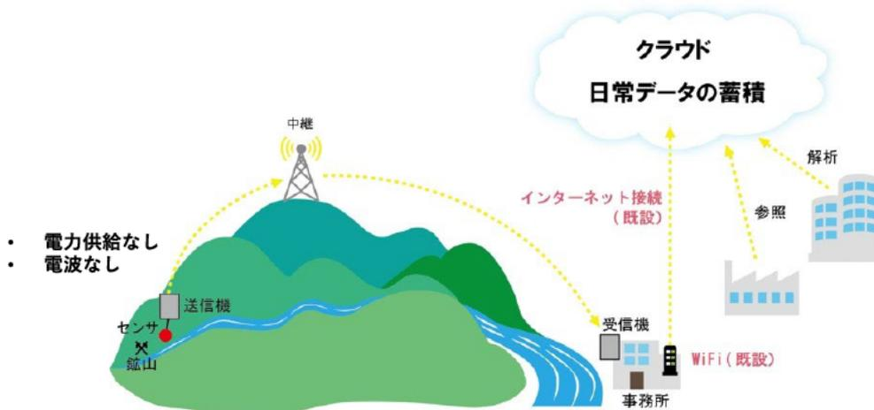
図 3-1 遠隔監視システムの概念図
