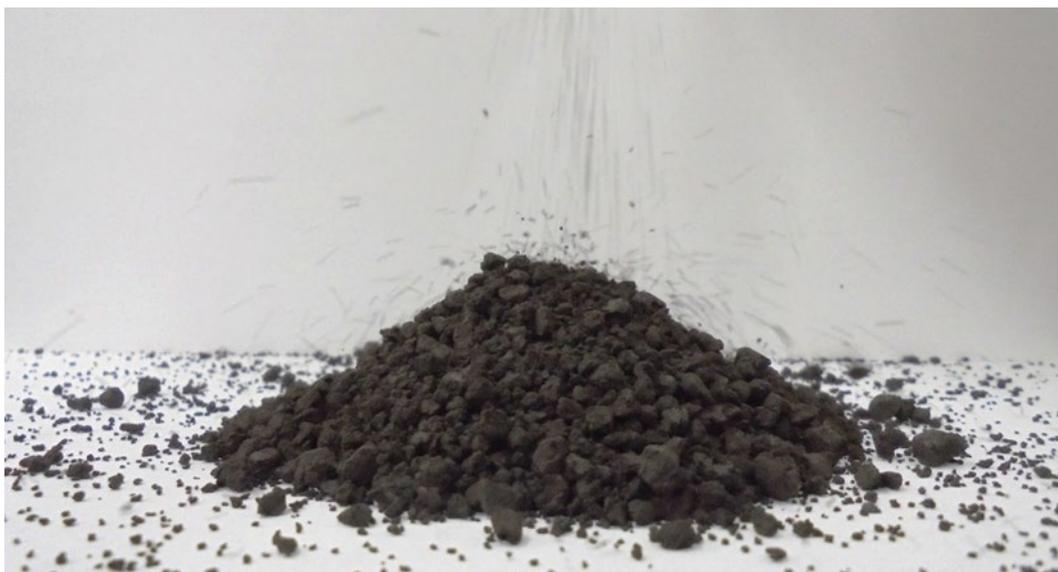
図 2.5-10 重金属吸着顆粒状鉄粉 MSI-XG の外観
