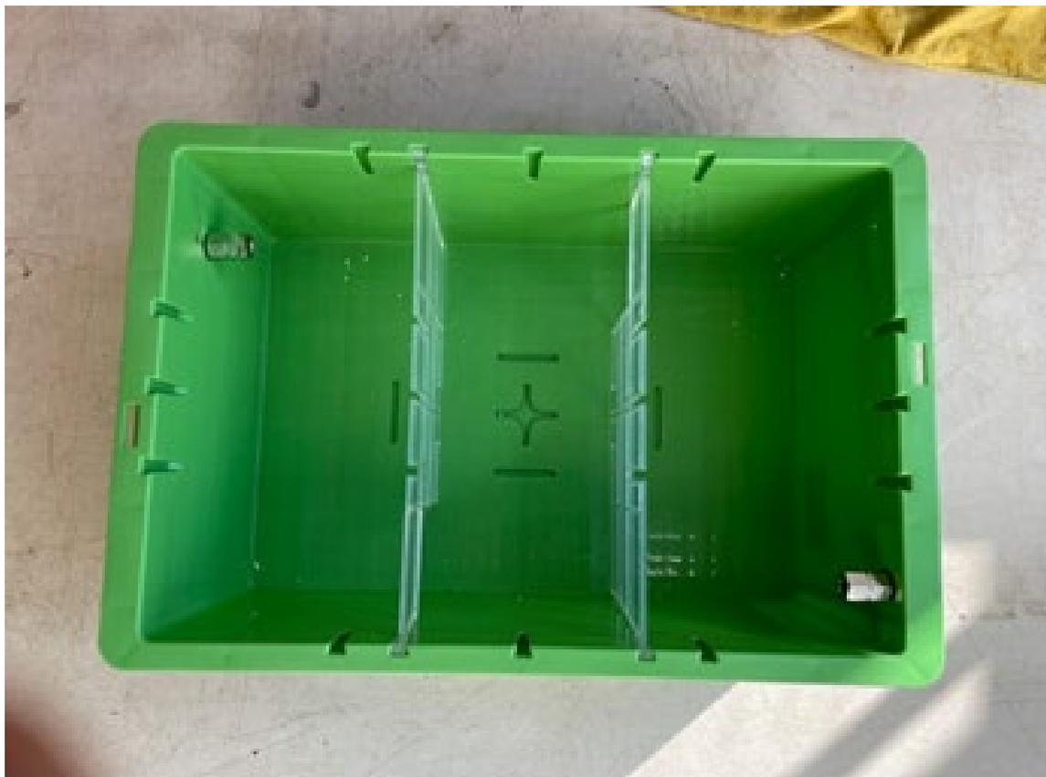
図 2.5-48 栽培に用いたタンク（表面積  $0.1\text{m}^2$ 、水深  $0.1\text{m}$ ）
