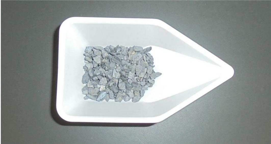
図 2.5-14 室内通水試験に使用した碎石
