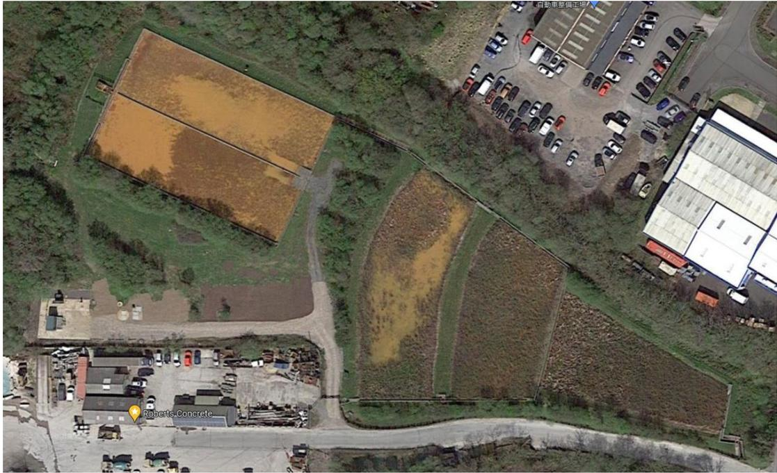
図 2.8-12 ①PT プロセスの様子 1 : カスケード+沈殿池+人工湿地
