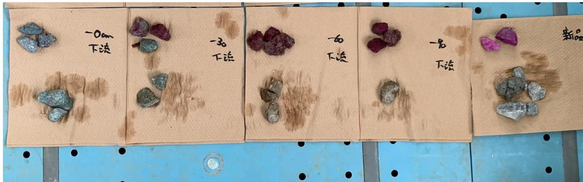
図 2.6-40 フェノールフタレインによる PAdeCS 表面のアルカリ性度合いの確認
