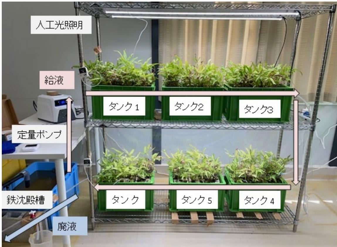
図 2.5-53 現地に設置した連続処理装置の概要
