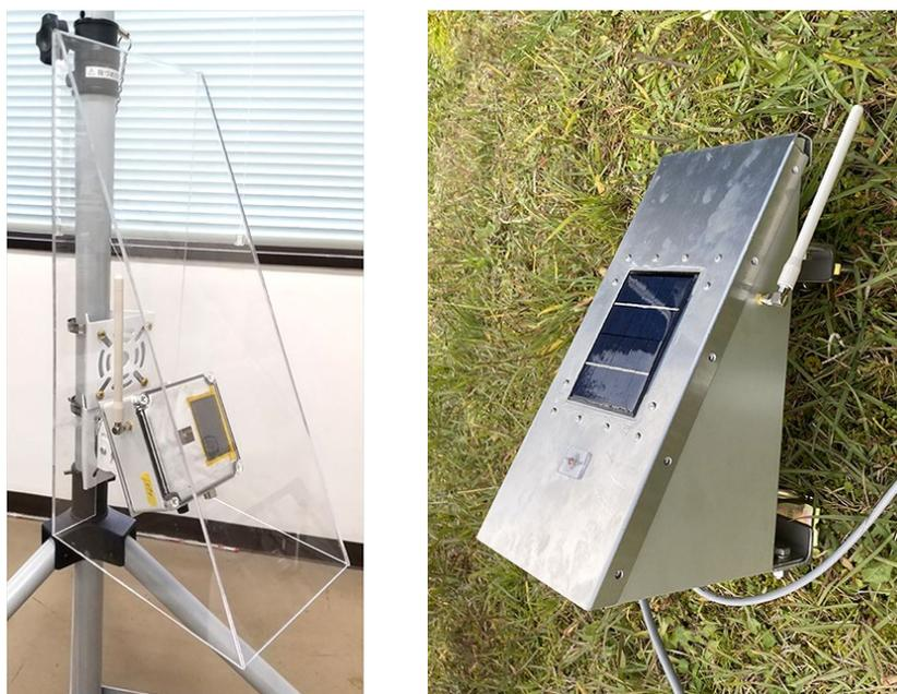
図 3-4 通信ユニットの雪除け対応 (左：アクリル板, 右：アルミニウム板)
