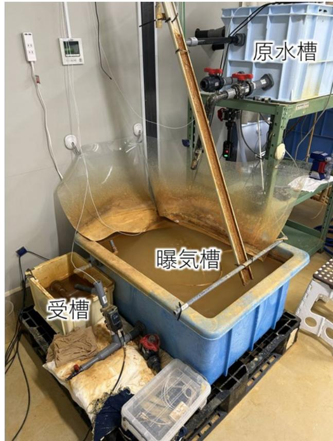
図 2.5-2 曝気槽通水試験設備の全景
