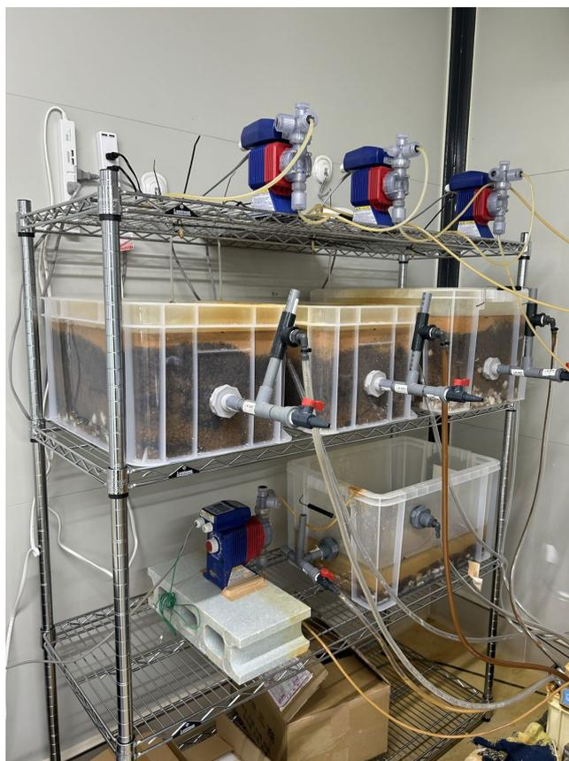
図 2.5-9 曝気ろ過槽通水試験設備
