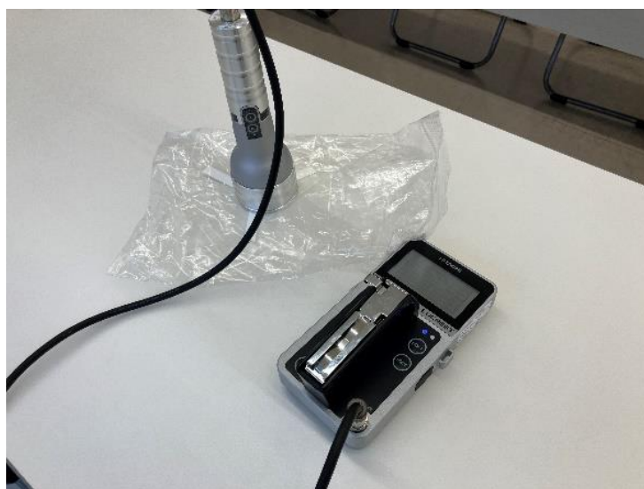
図 1-3 表面汚染密度の測定
