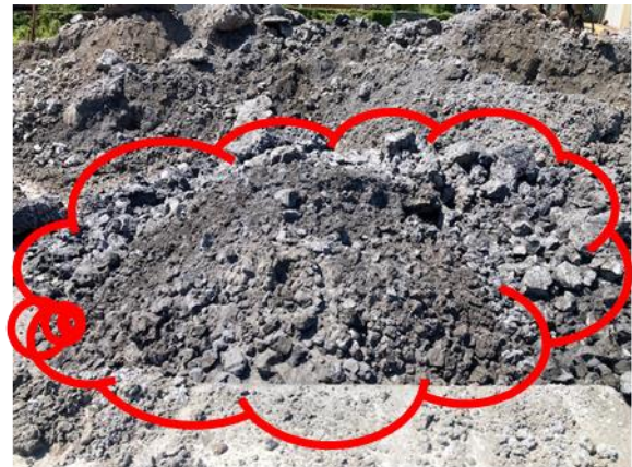
発生したスラグ
