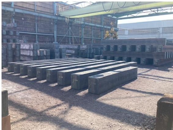
図 1-5 製造したブルーム及び発生したスラグの様子
