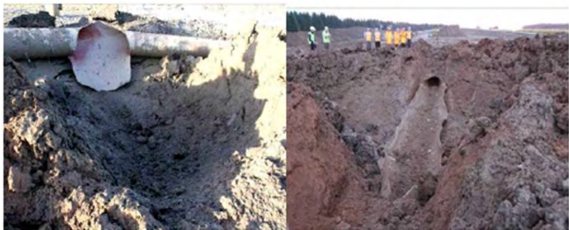
図 3.3-3 West Jefferson 実験結果（左は液体として、右はガスとしてのバースト形状）
