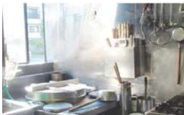
窓や勝手口を給気口、排気口としているケース
