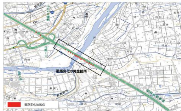
図 24. 車両プローブによる道路変化点の検出例
