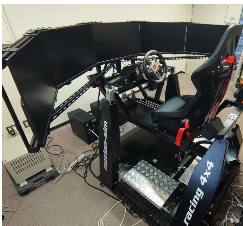
(a) 手動運転自動車挙動生成装置
