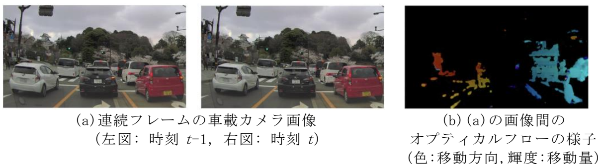
図 3.3. ②A-6 車載カメラ画像に対するオプティカルフローの様子
