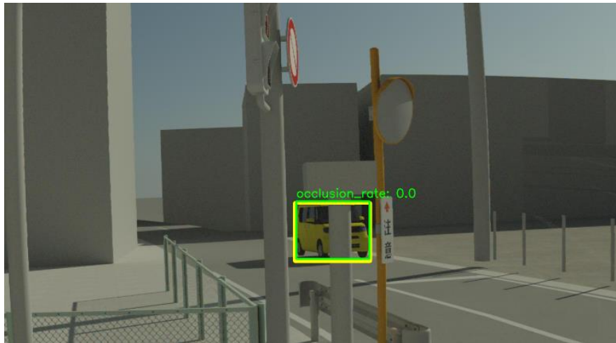
図 3.2. A-8 遮蔽率が正しく計算できていないシーン例
