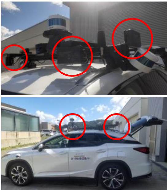
(a) 4D イメージングレーダの設置の様子 (赤丸がセンサ設置位置)
