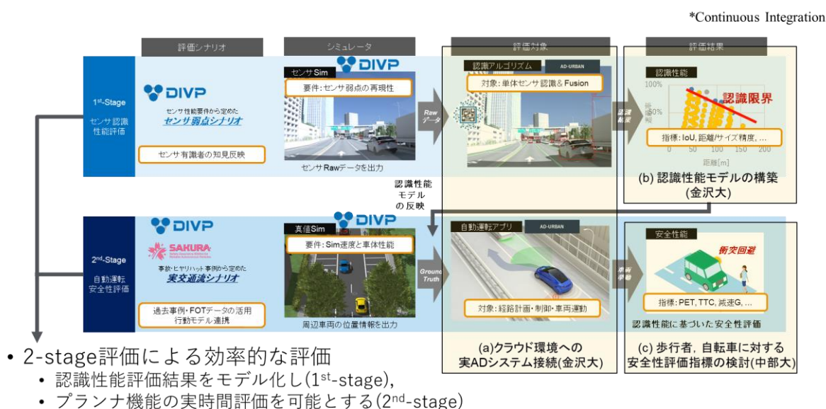
図 3.2. A-1 DIVP®/AD-URABAN/SAKURA プロジェクトで連携した 2-Stage 評価による CI 環境の構築 (出所: DIVP®プロジェクト)
