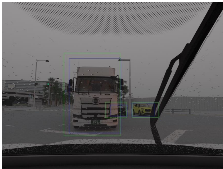
図 3.1.B-13 雨天時の遮蔽率の高いシーンにおける検出結果例 2 (緑色の枠が検出結果，青色の枠が正解矩形)
