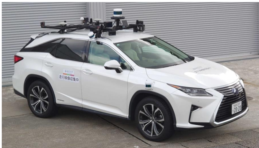
図 3.3. ①-1 実証実験に用いた自動運転車両の外観
