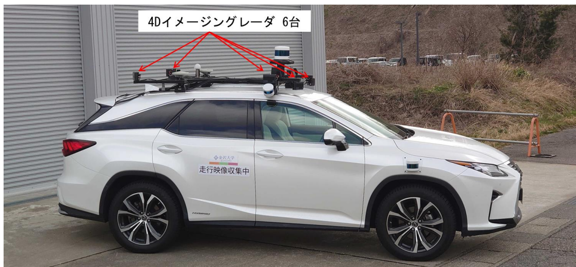
(b) 本事業で設置した 4D イメージングレーダ 図 3.3. ①-2 自動運転車両に搭載したセンサ
