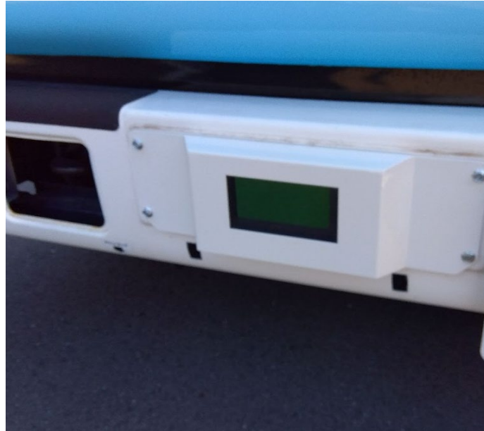
図 2.3-10 落下物検出用 LiDAR
