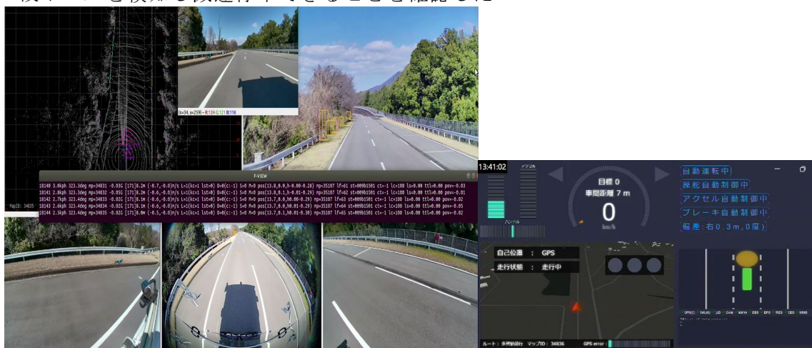
図 2.3-36 段ボールを検知し停車したときのタイミング
