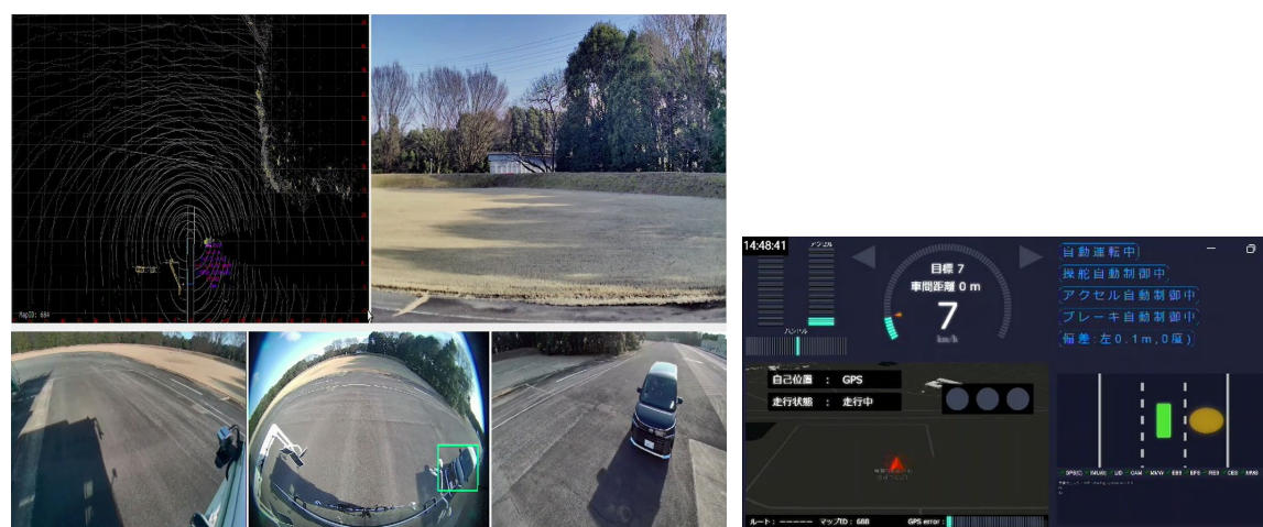
図 2.3-29 側方車両の停車を検知して発進したタイミング
