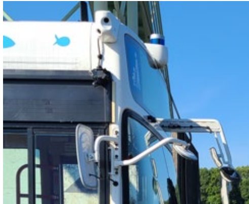
図 2.3-8 新設した側方カメラ
