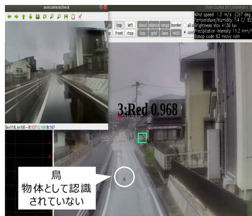
図 5.2.4-4 進行方向上の鳥とカメラの認識
