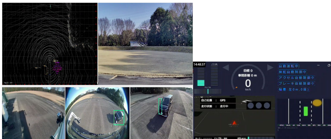
図 2.3-28 交差点で側方車両の動きを検知して停車したタイミング
