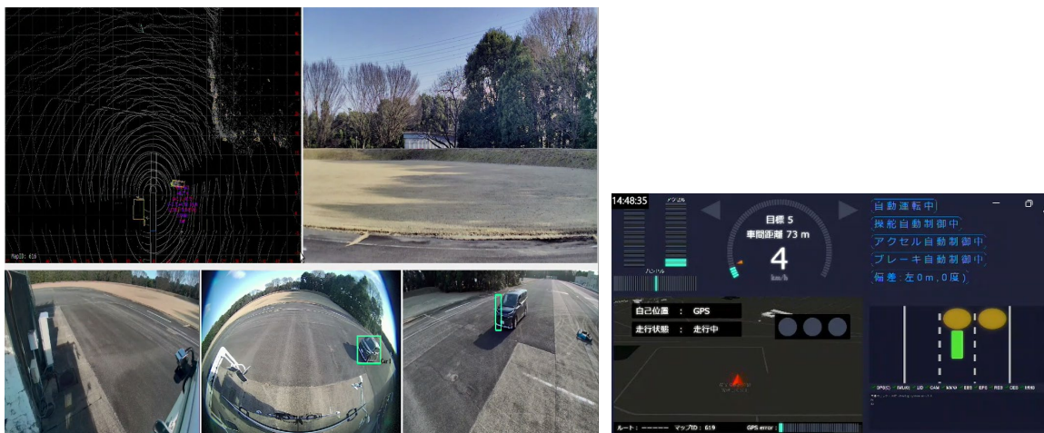
図 2.3-27 交差点で側方車両が自動運転バスと同時に発進したタイミング
