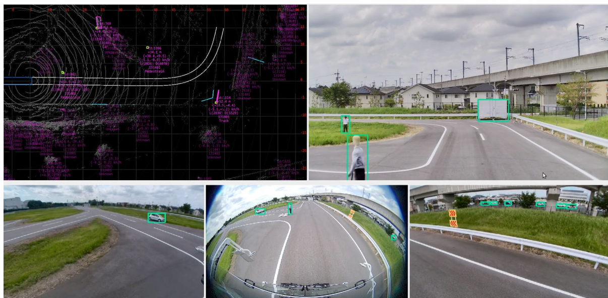
図 2.3-25 歩行者の飛び出しによる衝突を回避したタイミング
