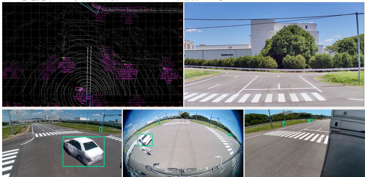
図 2.3-21 交差点での一時停止位置で車両が通り過ぎるまで停車しているタイミング
