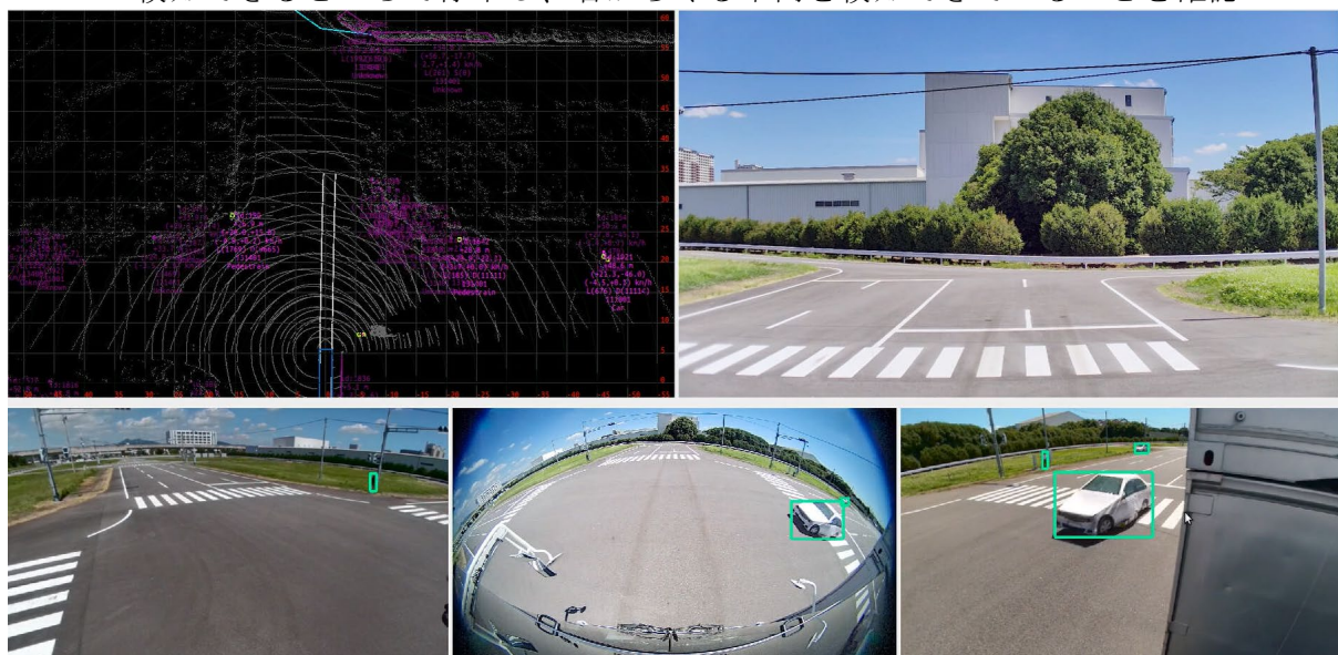
図 2.3-20 交差点での一時停止位置で右方からくる車両が近づいているタイミング
