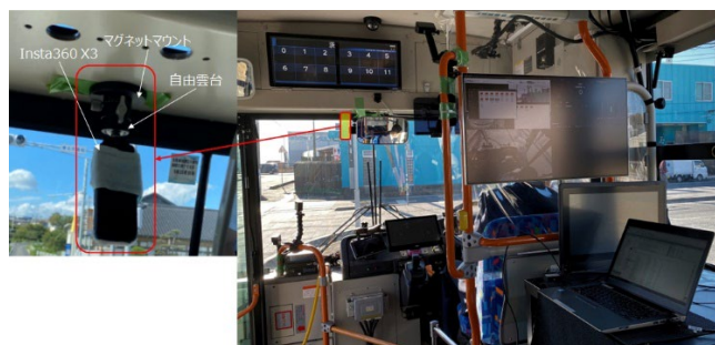
図 2.2-9 走行動画撮影用カメラと設置場所
