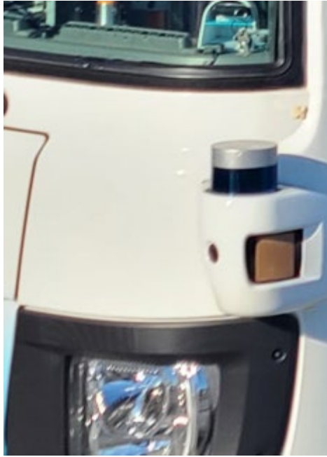
図 2.3-9 置換した BRT すれ違い信号認識カメラ
