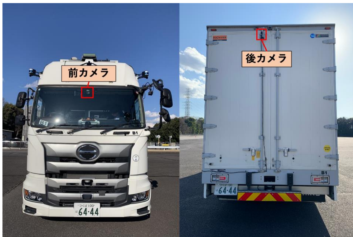
図 3.310 前カメラ・後カメラの搭載状態
