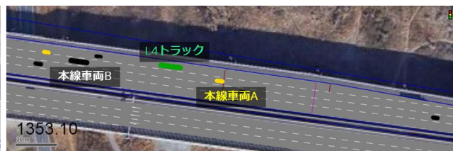
図 3.64 自車合流 協調制御システム (MRM 発生)
