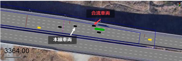
図 3.69 他車合流 協調制御による急減速発生
