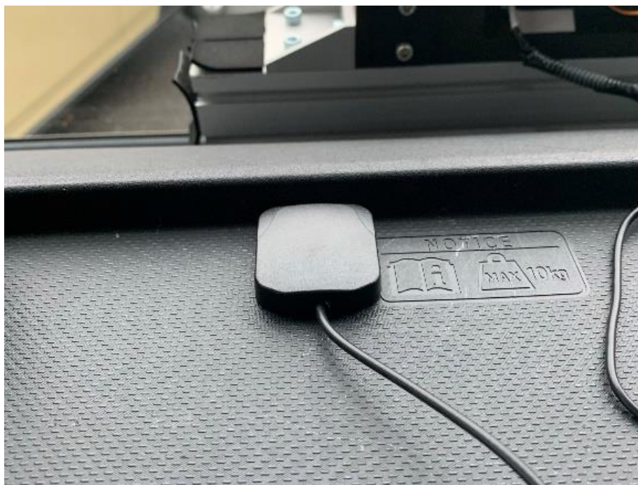
図 3.314 GNSS アンテナ配置状態
