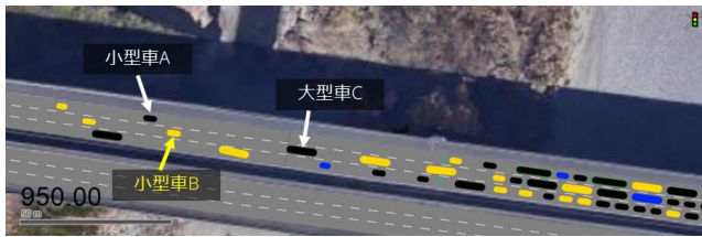
図 3.172 Close up による急減速の回避
