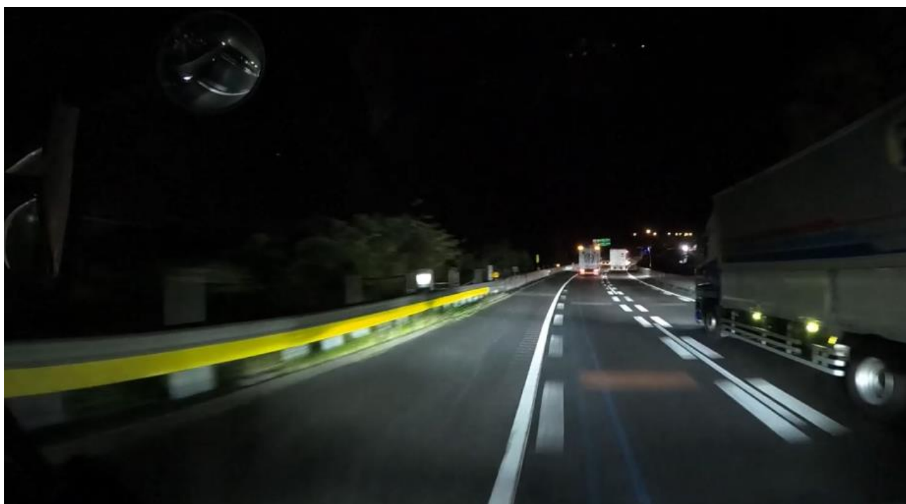
図 2.14 LKA 作動時における車線逸脱
