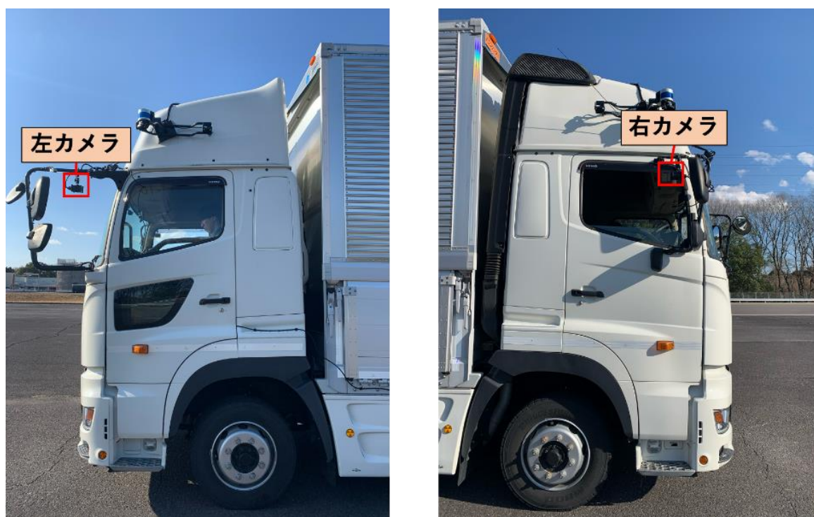
図 3.311 左カメラ・右カメラの搭載状態
