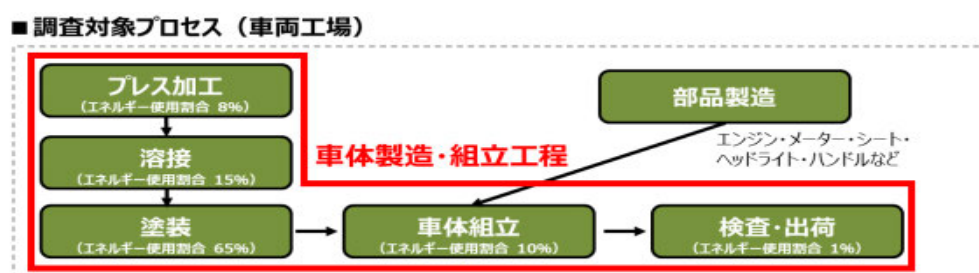
図表 2-53 車体製造・組立工程におけるプロセス別エネルギー使用量
