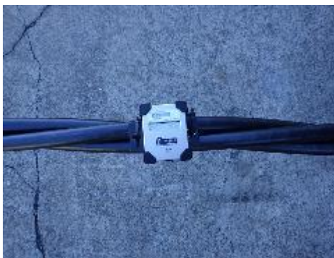
加速度計(試験時は保護)
