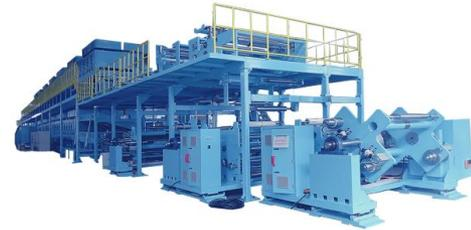
宽幅高速双层挤压涂布分切一体机
