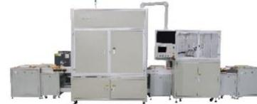
软包电池模组激光自动焊接系統
