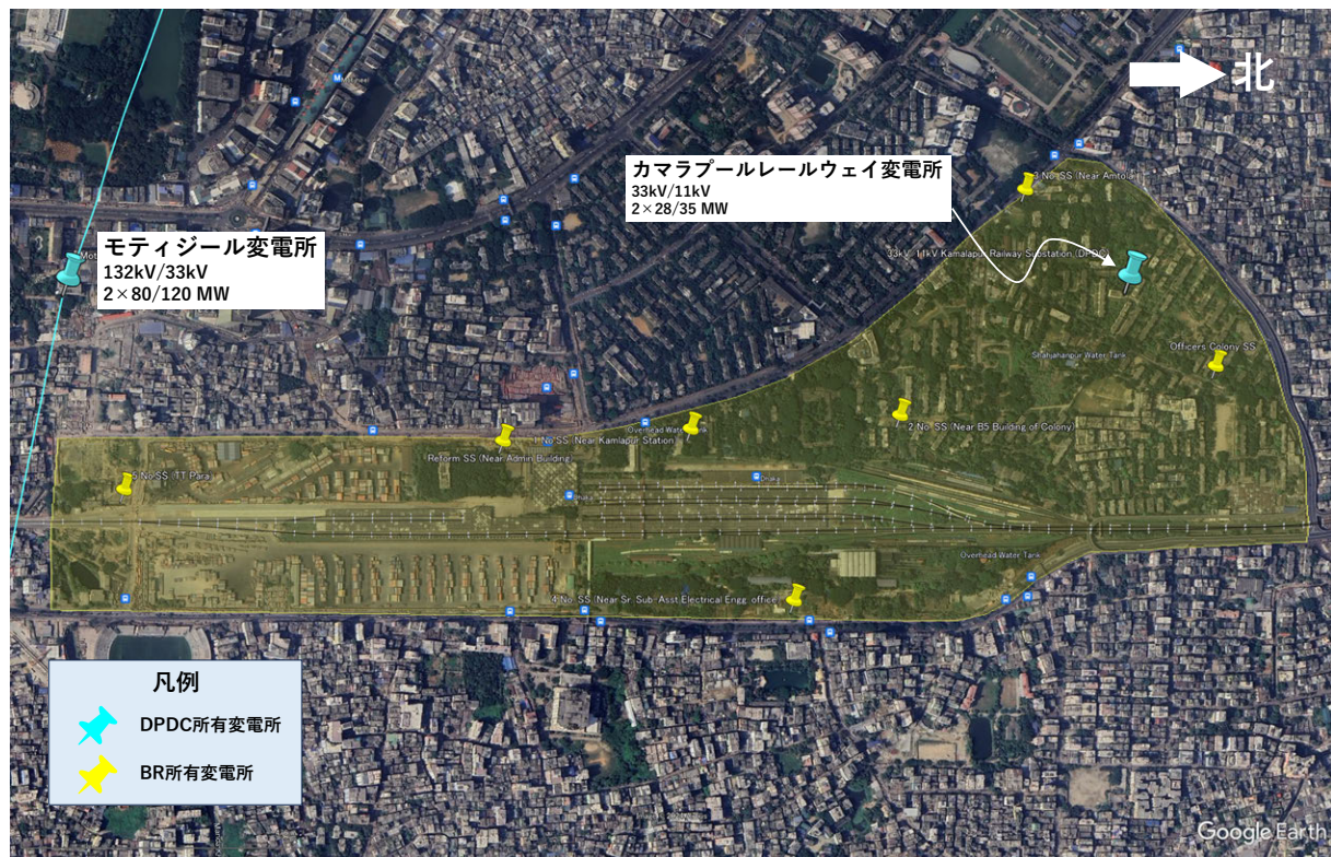
図 2.10.6 開発エリア周辺の電力設備敷設状況
