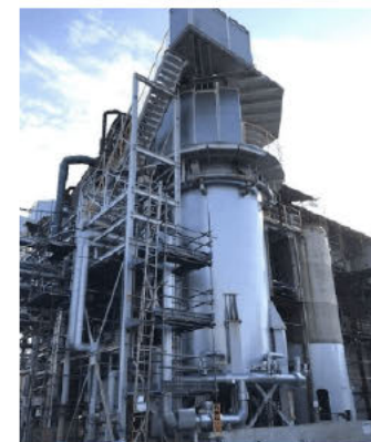
量産化のための培養槽
