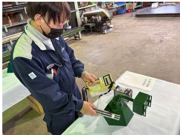
図 5.1.2. 加工後製品(防犯灯) 表面線量測定
