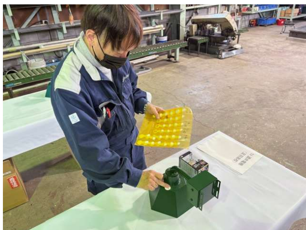
図 5.1.3. 加工後製品(防犯灯) 汚染検査(スミア採取)
