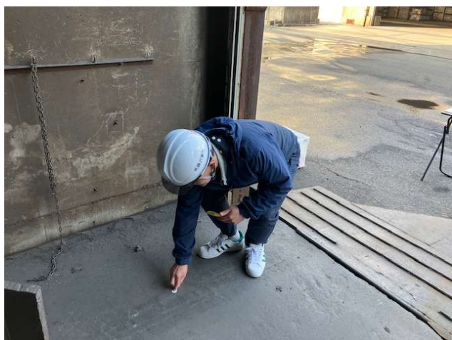
図 5.1.3. 加工工場作業エリア(屋内) 汚染検査(スミア採取)
