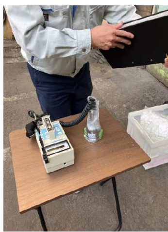
図 5.1.4. 加工工場作業エリア(屋内) 汚染検査(スミア測定)
