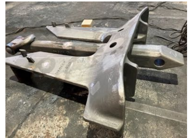
f. アンカー組み立て
