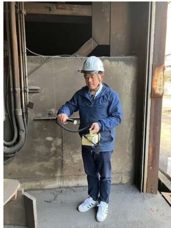
図 5.1.2. 加工工場作業エリア(屋内)空間線量測定
