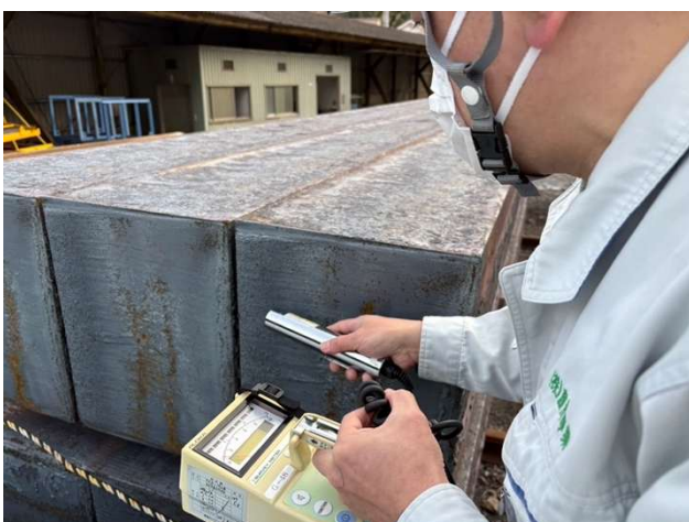
図 5.1.9. 加工後製品 (ブルーム) 表面線量測定
